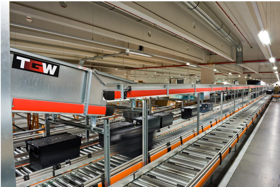
Рисунок 1.4 – Роликова транспортна система для переміщення штучних вантажів і палет
