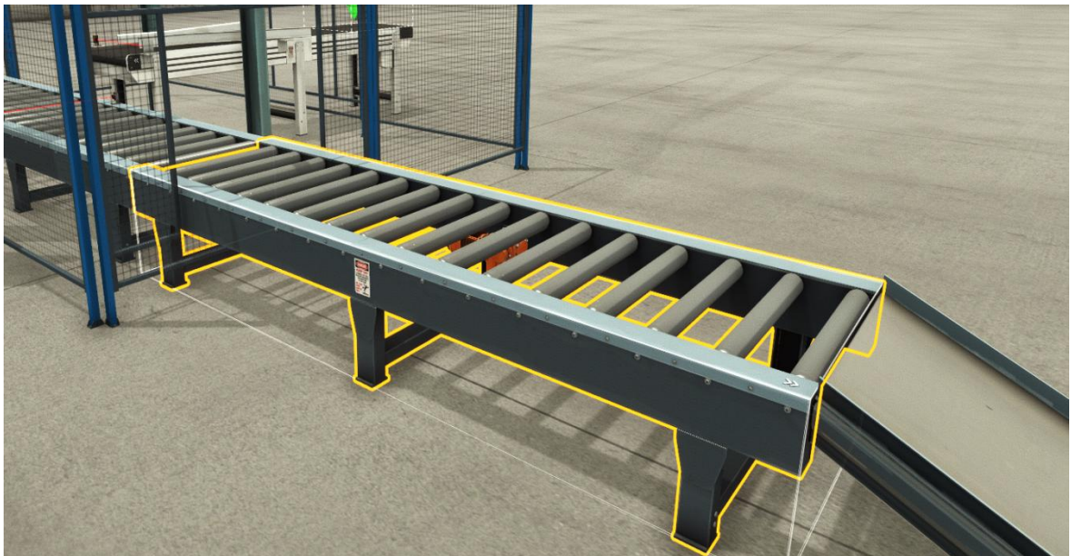
Рисунок 2.7 – Вихідний роликівий конвеєр готових палет
