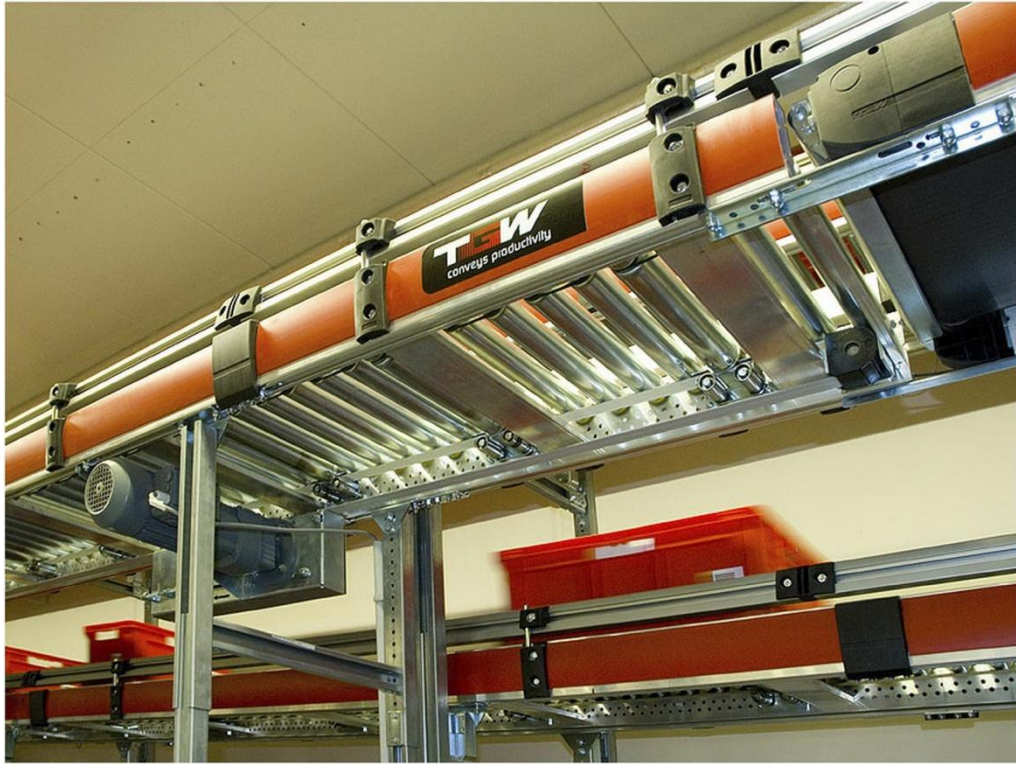
Рисунок 1.2 – Приклад роликового конвеєра для переміщення коробок, контейнерів або подібних штучних вантажів
