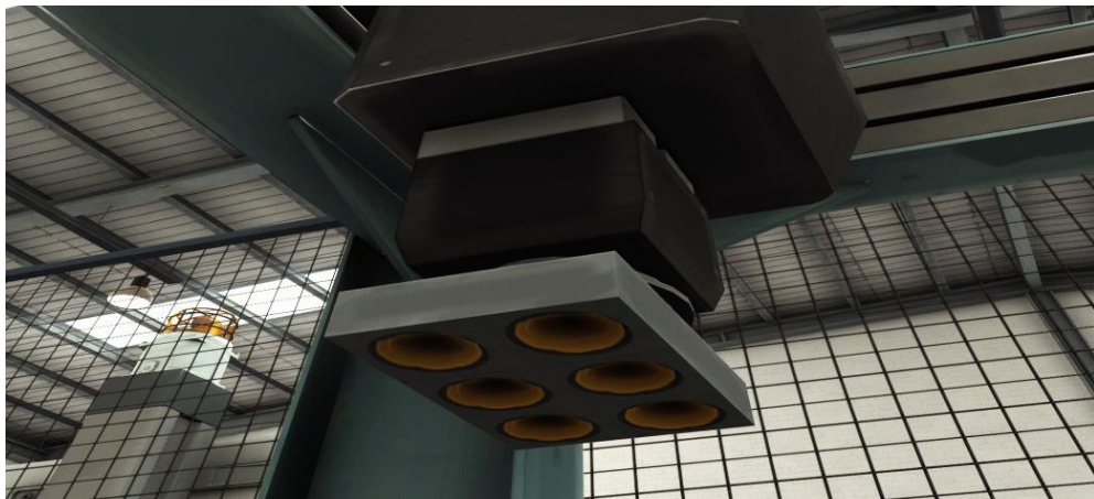
Рисунок 2.13 – Пневматичний захват і датчик вакууму
