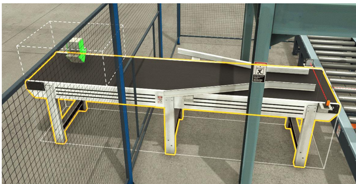
Рисунок 2.4 – Стрічковий конвеєр подачі коробок із центрувальними напрямними
