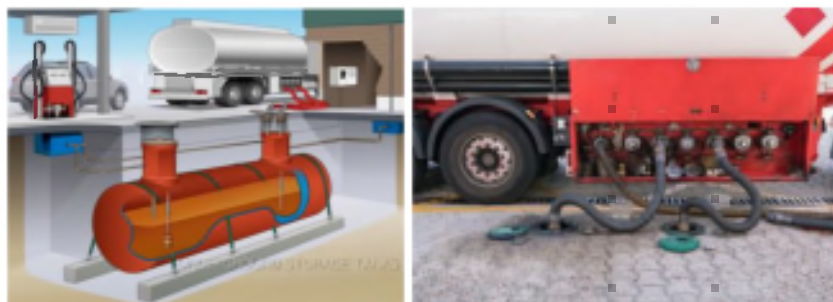
Рисунок 1.9 – Підземний резервуар для нафтопродуктів та метод заправки
