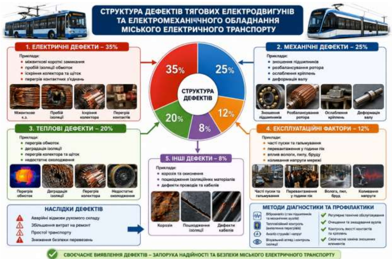
Рисунок 2.1 - Структура дефектів ТЕД та ЕМО [14]
