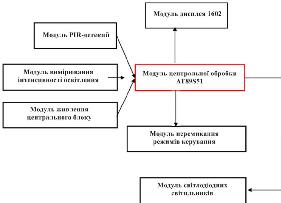
Рисунок 2.4 – Структурна декомпозиція апаратних модулів пристрою керування
