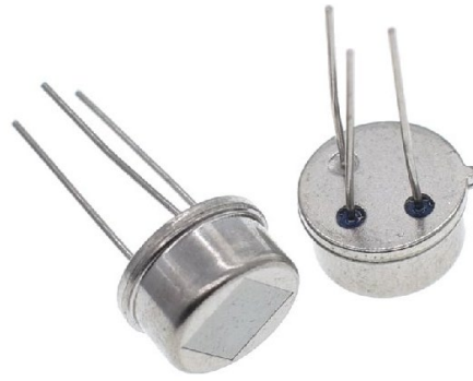
Рисунок 2.11 – Конструктивне виконання піроелектричного сенсора моделі RE200B
