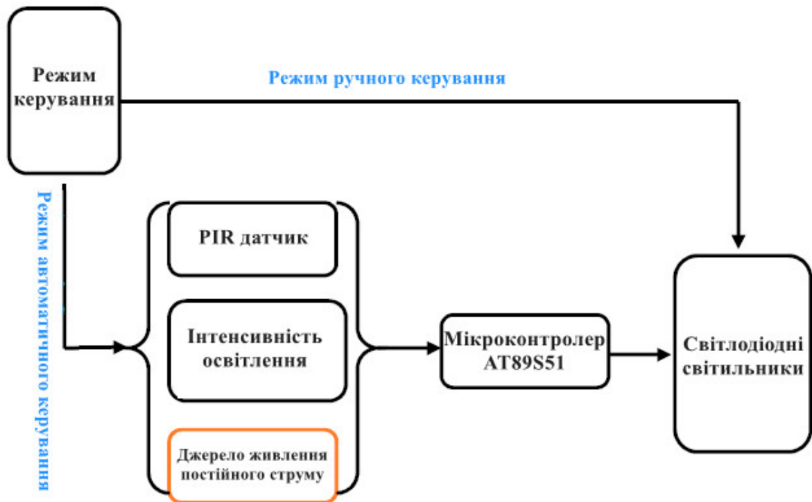
Рисунок 2.3 – Узагальнений алгоритм функціонування адаптивного світлотехнічного комплексу
