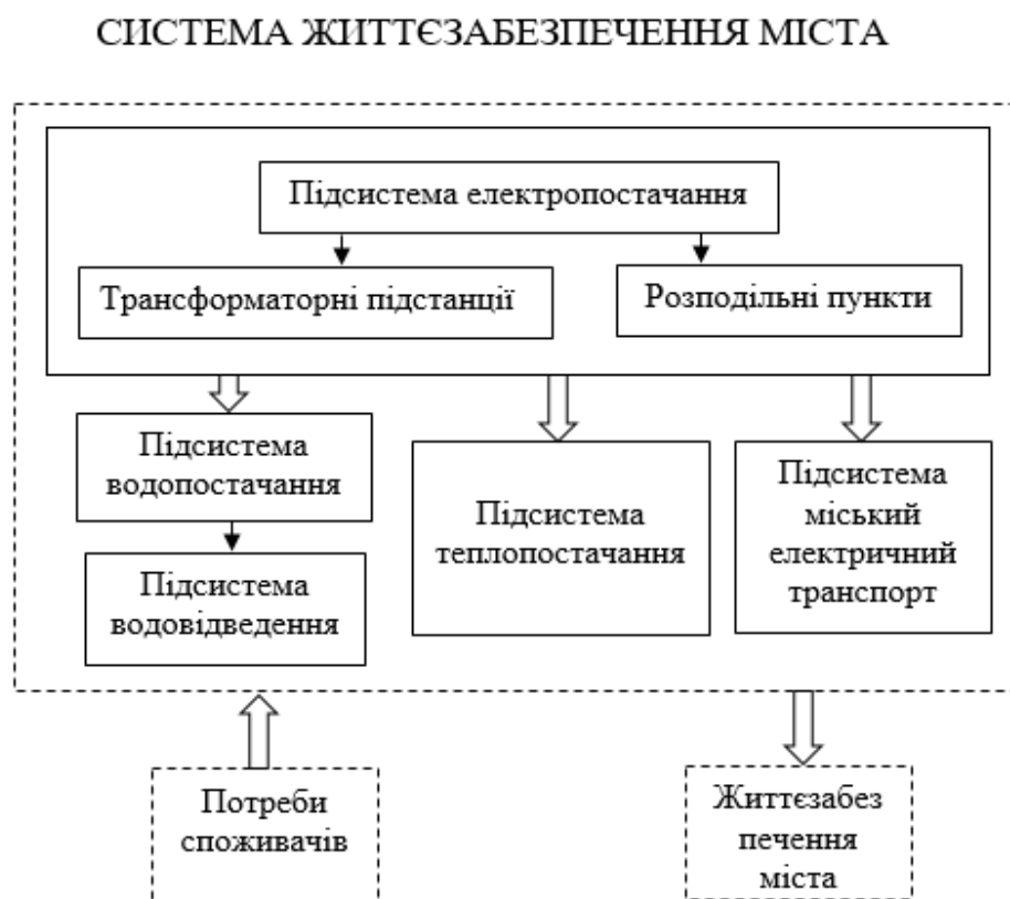
Рисунок 1.1 – Функціональна схема системи життєзабезпечення міста
