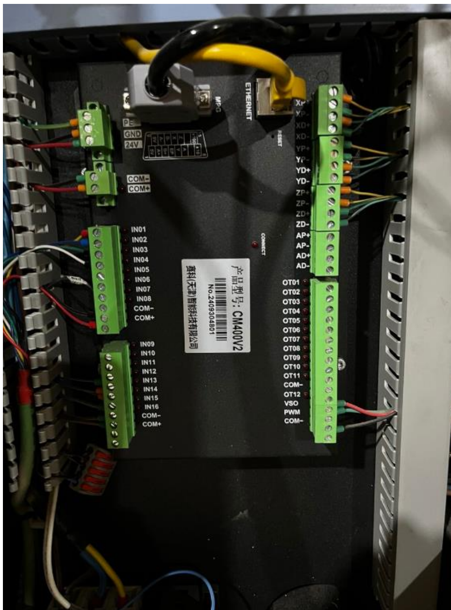
Рисунок 2.7 – Центральний обчислювальний модуль ЧПК CyclMotion CM400V2 з підключеними інтерфейсами
