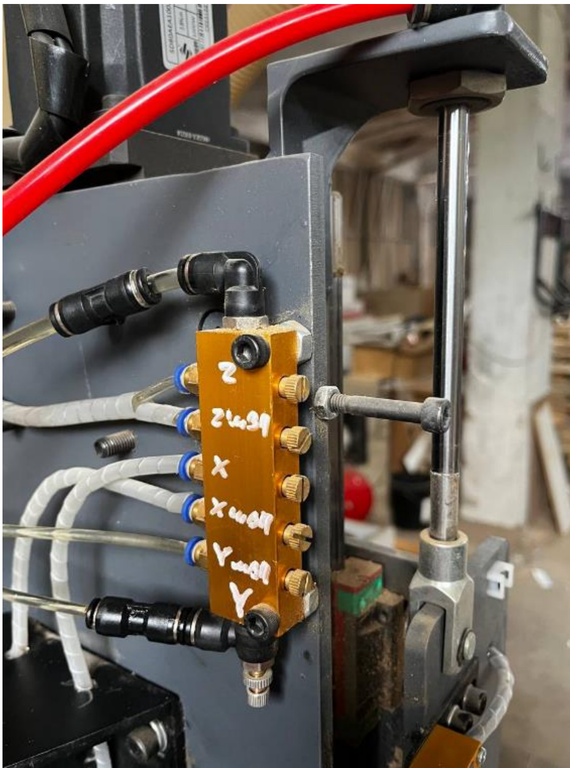
Рисунок 2.4 – Розподільчий блок змащування координатних осей
