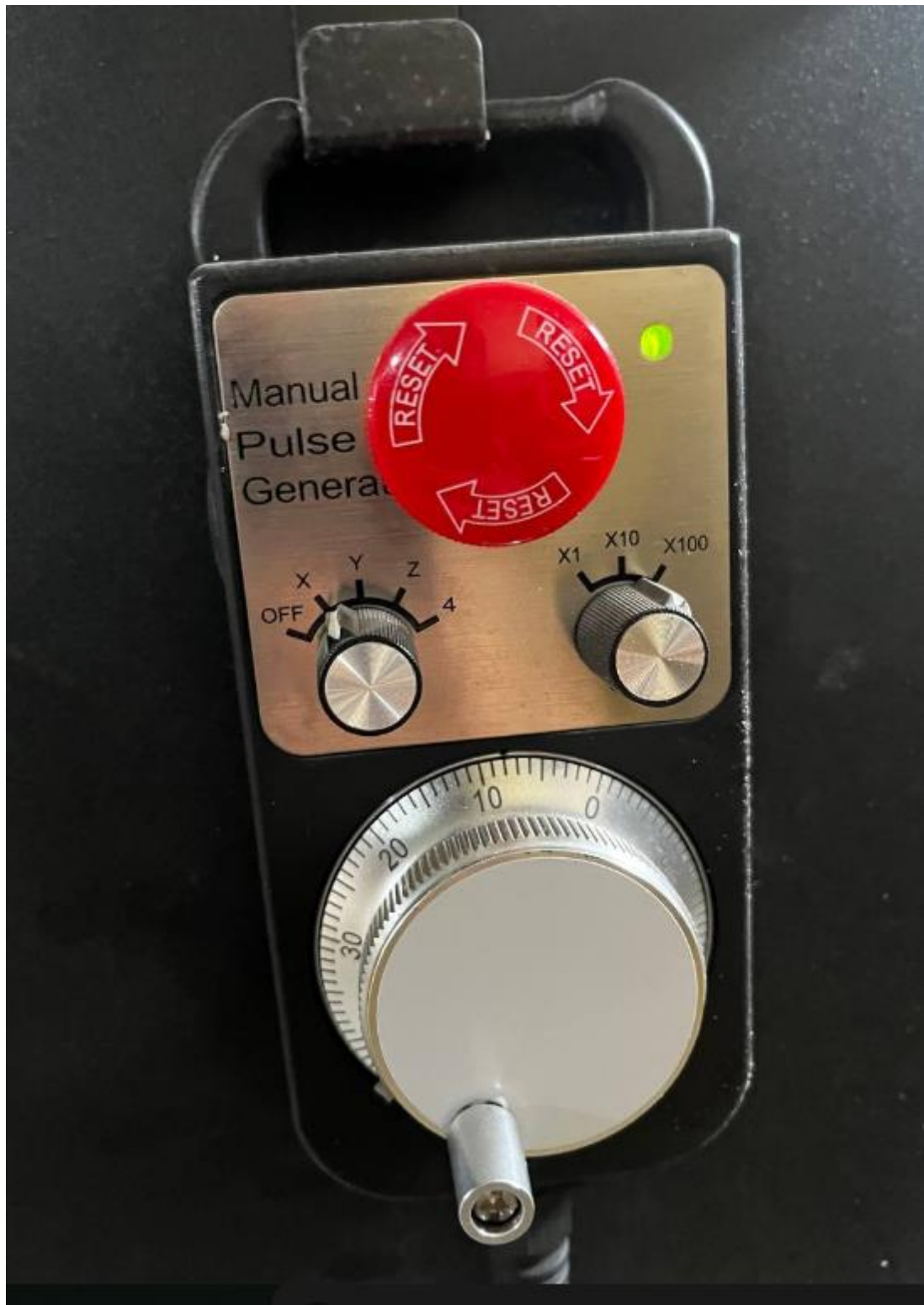
Рисунок 2.9 – Виносний ручний пульт керування верстатом (генератор імпульсів MPG)
