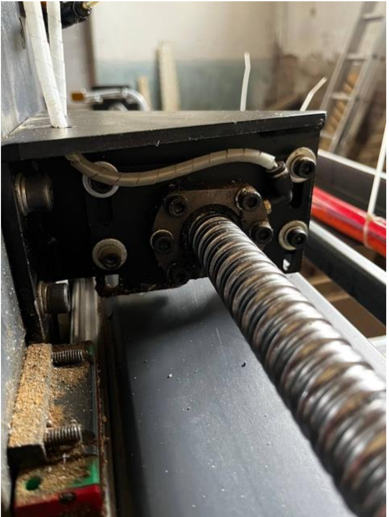
Рисунок 2.2 – Вузол КГП та лінійних напрямних реального верстата
