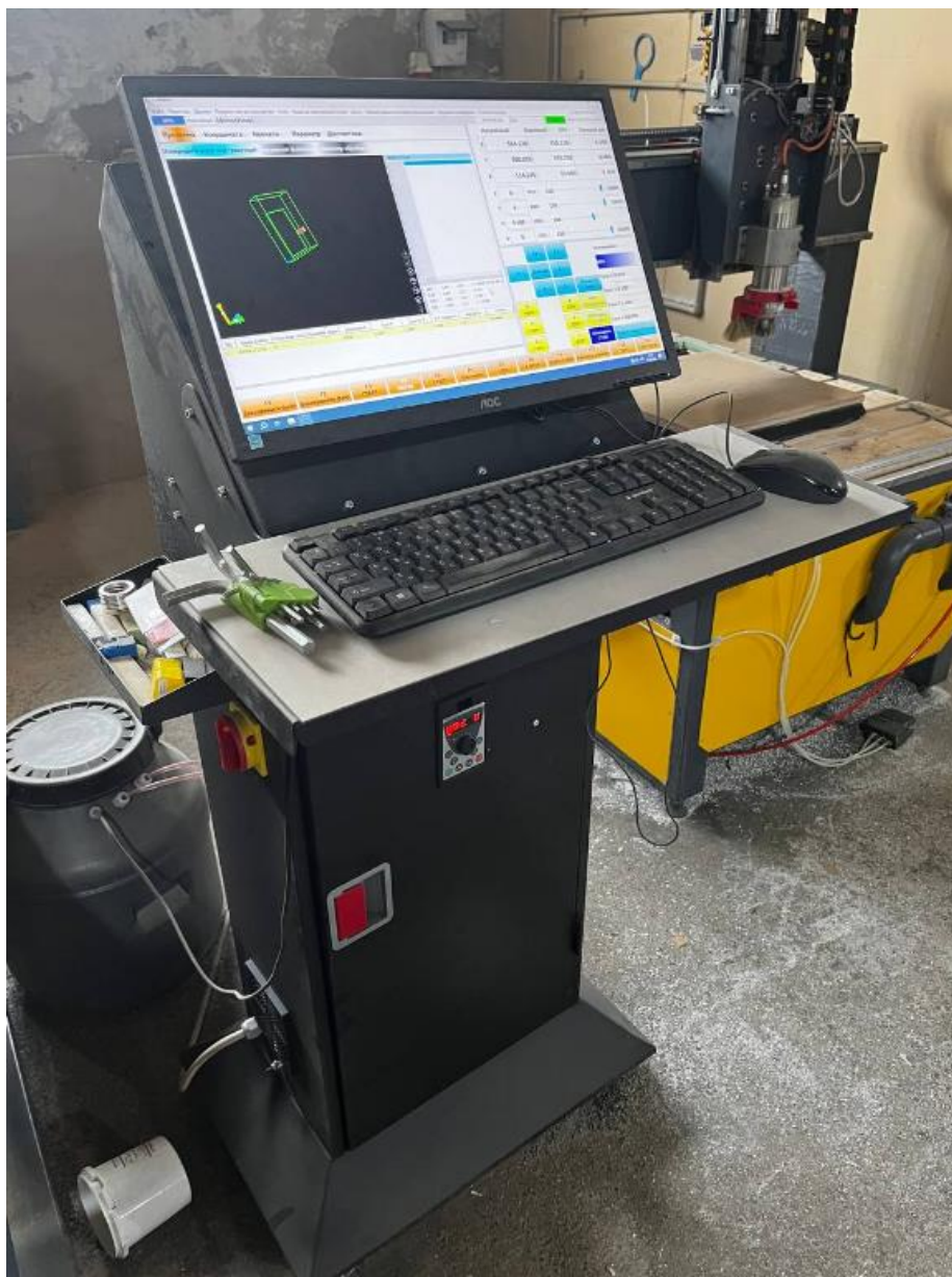
Рисунок 3.2 – Загальний вигляд промислової консолі оператора з інтерфейсом CyclMotion
