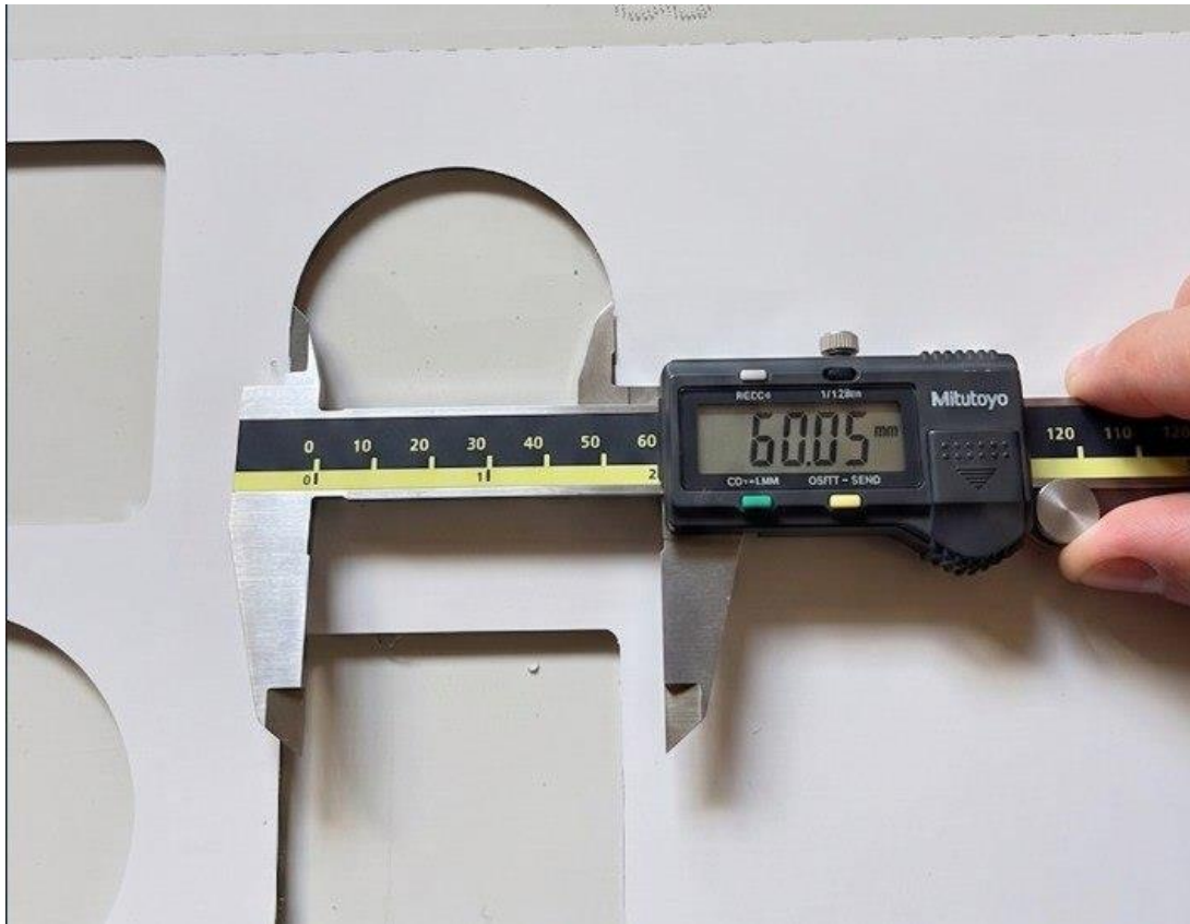
Рисунок 3.6 – Вимірювання внутрішнього контуру кола: факт. 60,05 мм ( \Delta = +0,05 мм)
