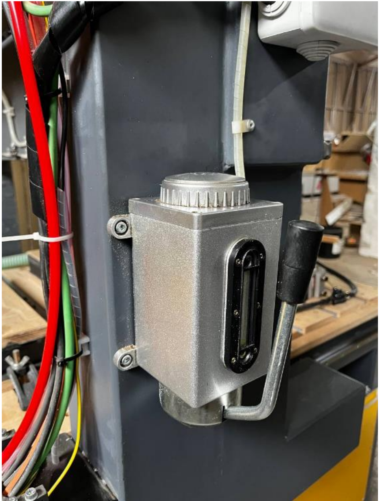
Рисунок 2.3 – Ручний плунжерний насос централізованої системи змащування об'ємом 0.5 л
