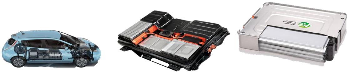
Рисунок 2.1- Електро-хімічні акумулятори, що використовують на електромобільному транспорті (акумуляторні елементи Nissan Leaf)
