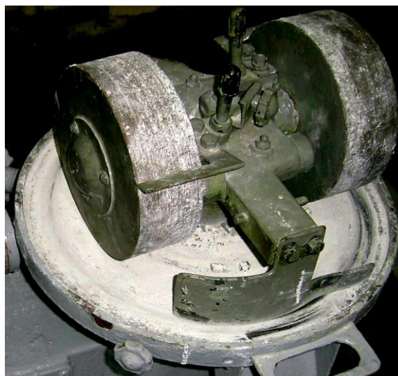
Рисунок 6.4 – Схема та загальний вигляд бігунів з нерухомою чашею: 1 – нерухома чаша; 2 – нерухома вісь; 3, 6 – гладкі валки, 4, 5 – плужки; 7 – пневматичний циліндр; 8 – тяга; 9 – розвантажувальне вікно
