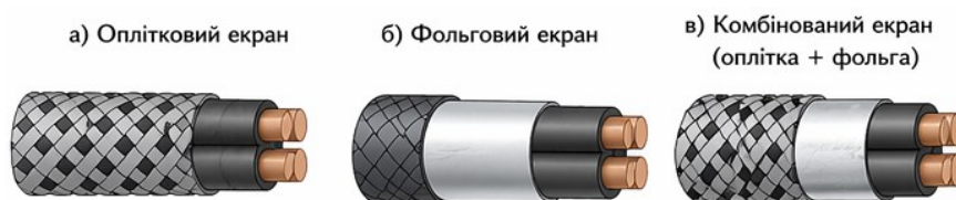
Рисунок 3.5 – Типи екранування кабелів
