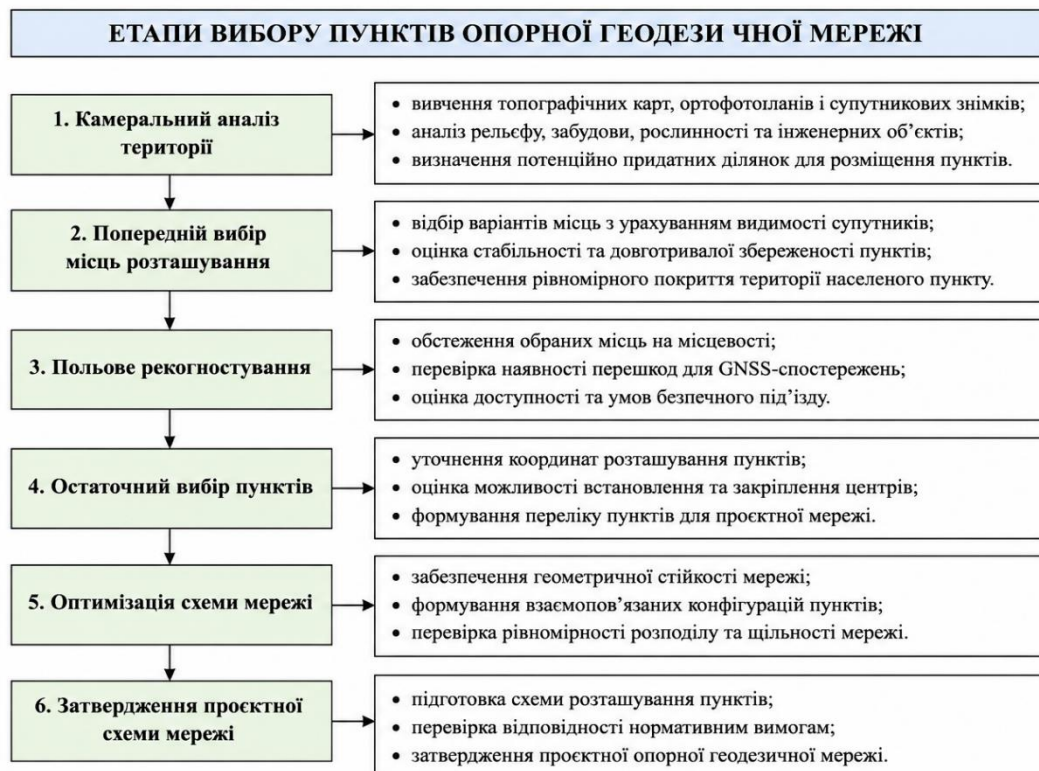
Рисунок 2.3 – Етапи вибору пунктів опорної геодезичної мережі
