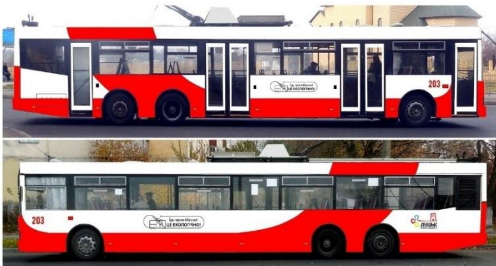
Рисунок 1.4 – Тролейбус Богдан - 231 з підтримуючим мостом
