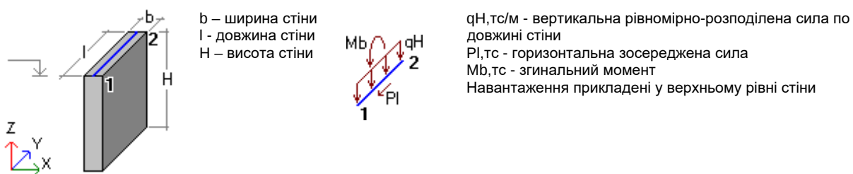
Рисунок 23 – Розрахункова схема стіни
