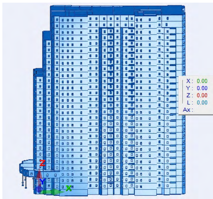
Рисунок 1 – Розрахунково-аналітична модель будівлі, побудована в модулі «Сапфір» програмного комплексу «ЛІРА»
