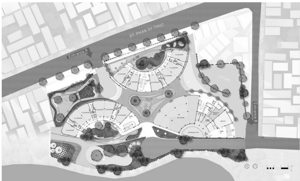
Рис. 1.8. Генеральний план, суміщений з планом першого поверху, та організація прилеглої території закладу дошкільної освіти «EcoKid Kindergarten»
