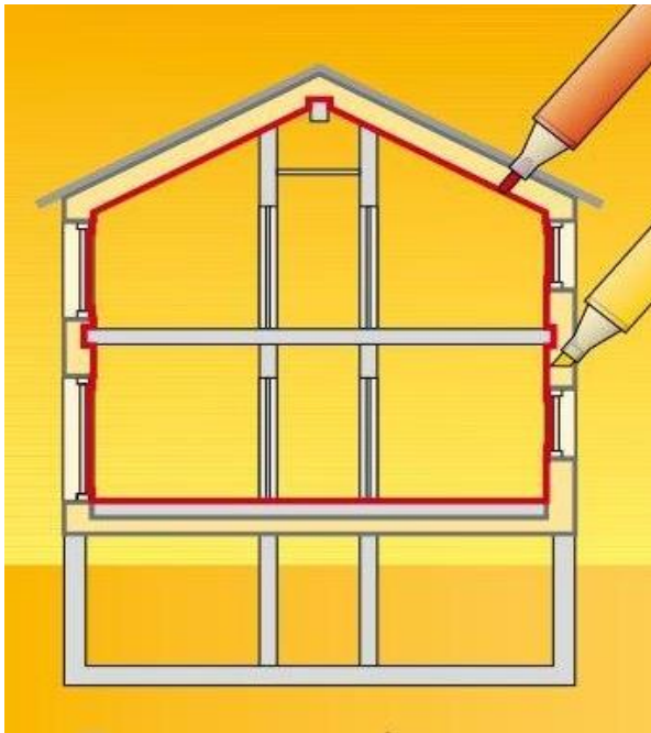
Рисунок 3.5 – «Правило олівця» – Оболонка будинку має неперервний контур утеплення та є повітронепроникною
