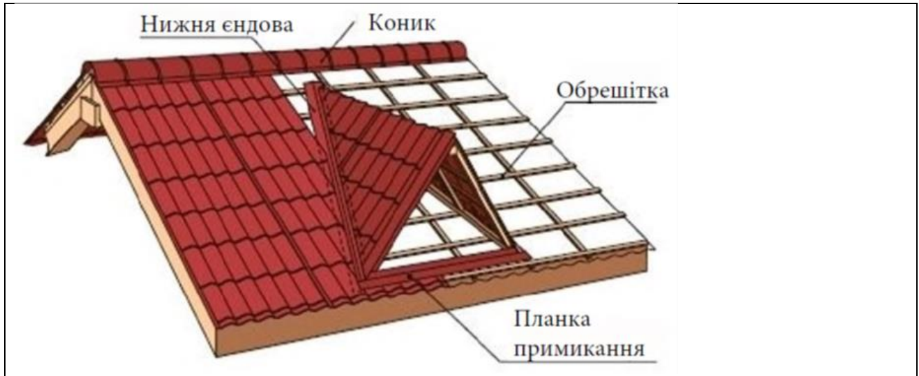
Рисунок 6.24 – Монтаж слухового вікна
