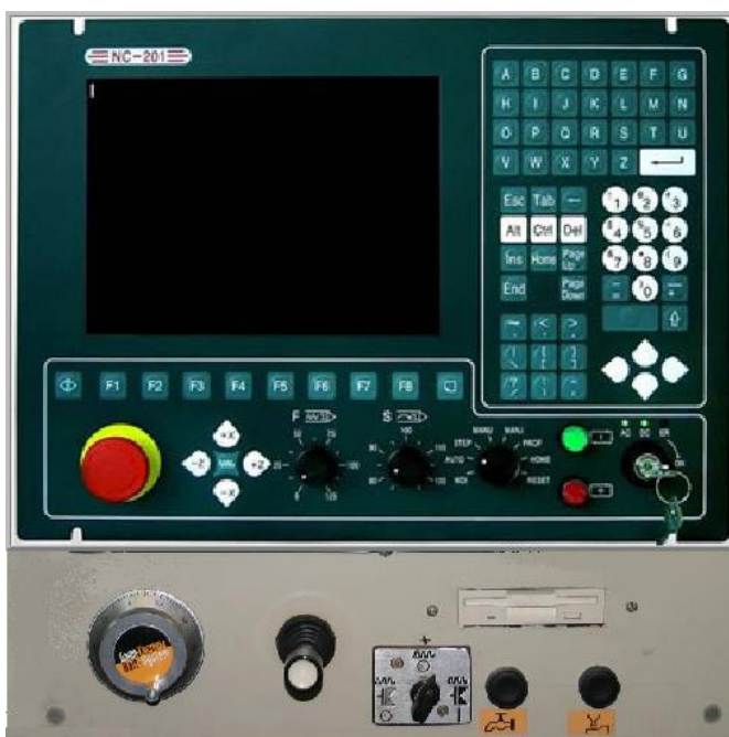
Рис. 1.3 - Інтерфейс пульта числового програмного керування токарного верстата 16K20.
