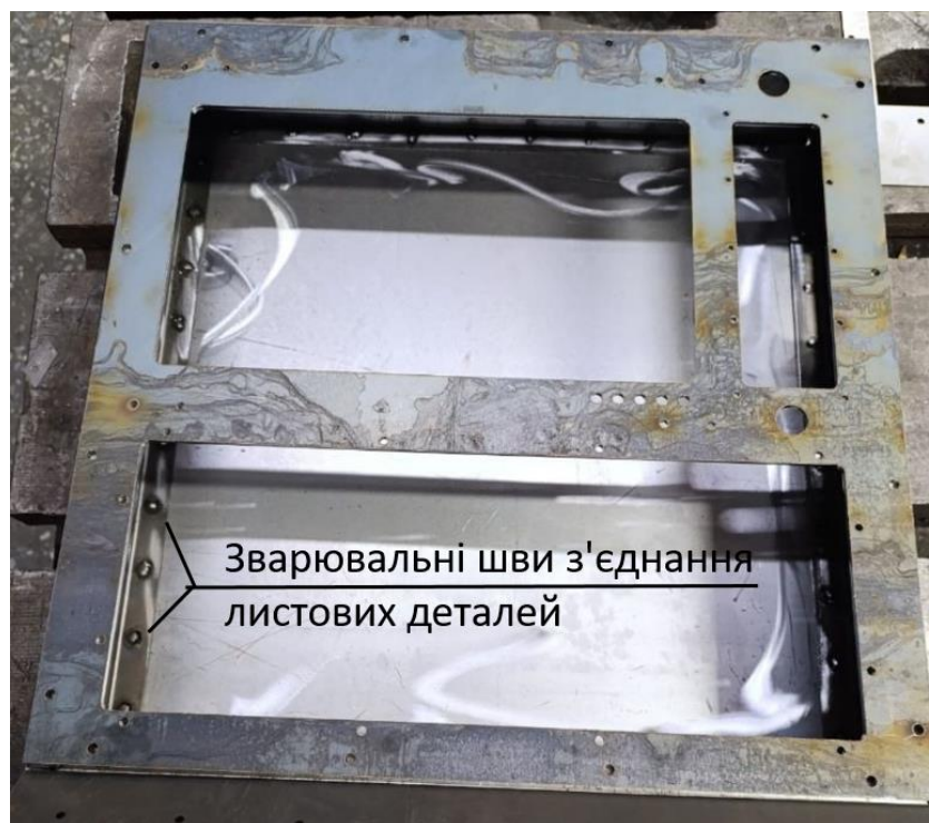
Рисунок 2.20 – Корпус пульта керування після зварювання та герметизації
