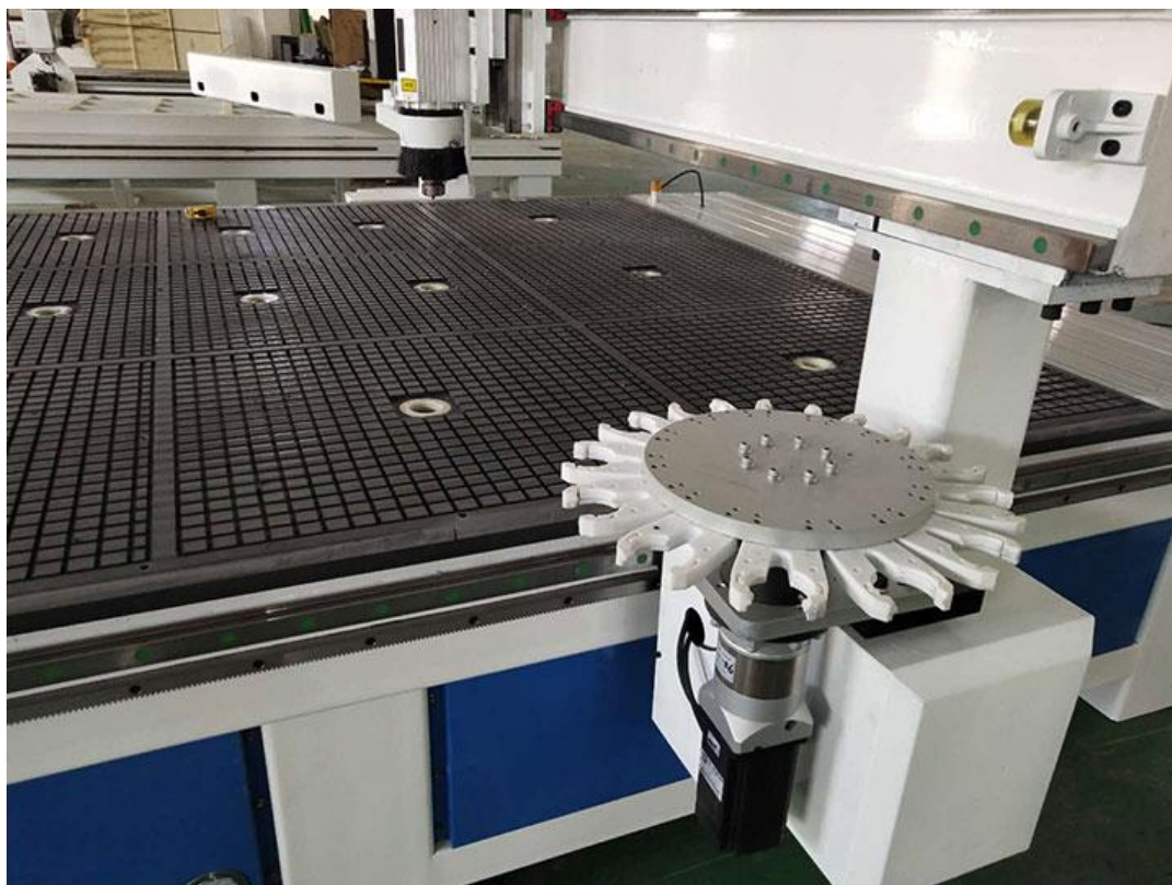
Рисунок 1.4 - Автоматизована система зміни інструмента фрезерного верстата з числовим програмним керуванням. [10]
