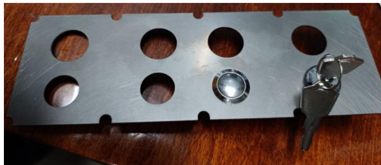
Рисунок 2.6 - Фізичний прототип пластини панелі увімкнення на етапі макетування
