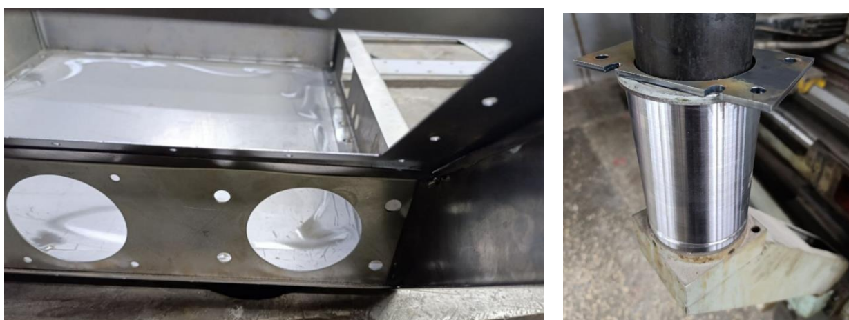
Рисунок 2.21 – Зварна рама корпусу пульта керування та вузол поворотного кронштейна пульта керування
