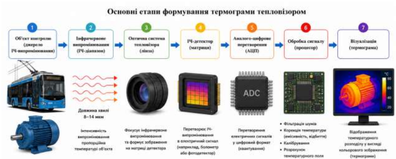
Рисунок 1.3 – Схема формування термограми тепловізором при діагностиці електромеханічного обладнання МЕТ [3]
