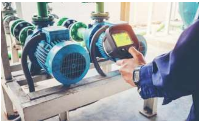
Рисунок 1.8 - Теплова діагностика тягового електродвигуна [3,4]
