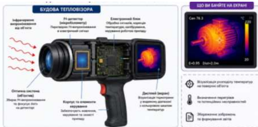
Рисунок 1.1 – Будова тепловізора для діагностування електрообладнання
