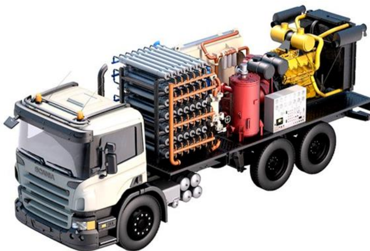
Рисунок 15.4 – Азотна компресорна станція ТГА
