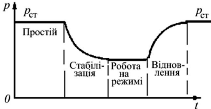
Рисунок 7.3 – Характер зміни тиску при дослідженні газової свердловини на одному режимі
