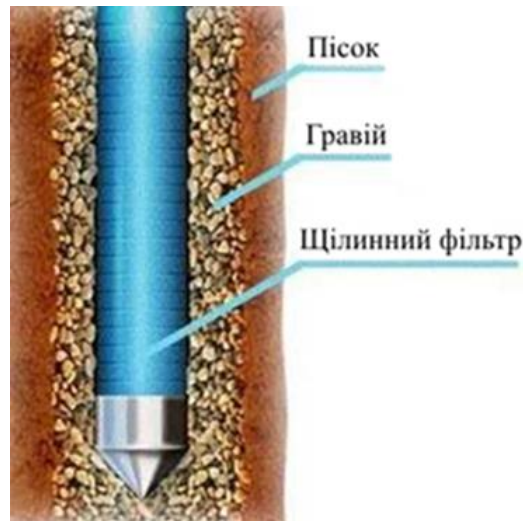
Рисунок 12.8 – Гравійний фільтр у свердловині
