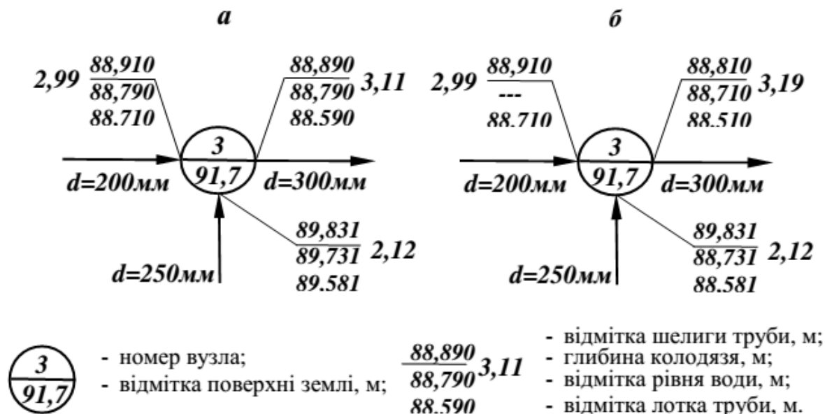
Рисунок 6.2 – Схема висотної ув'язки труб [5]
