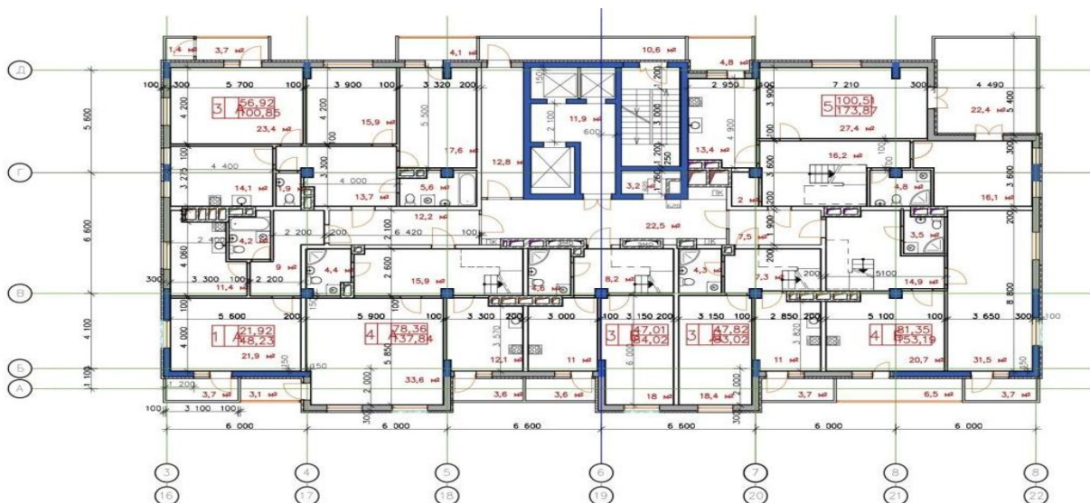
Рисунок 1.2 – План типового поверху будівлі
