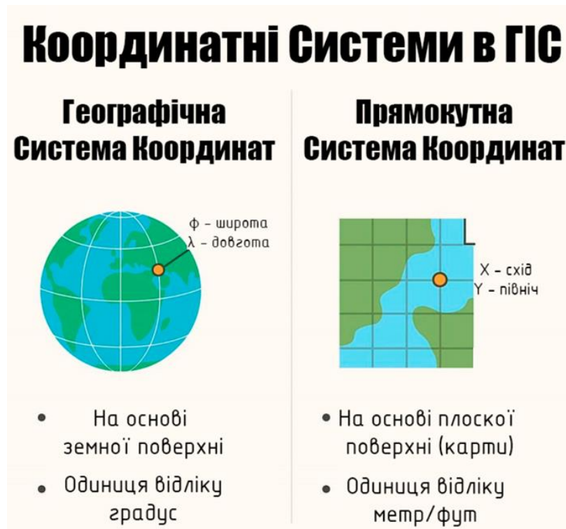
Рисунок 2.2 – Принципова відмінність між географічною (GCS) та проєкційною (PCS) системами координат [17]
