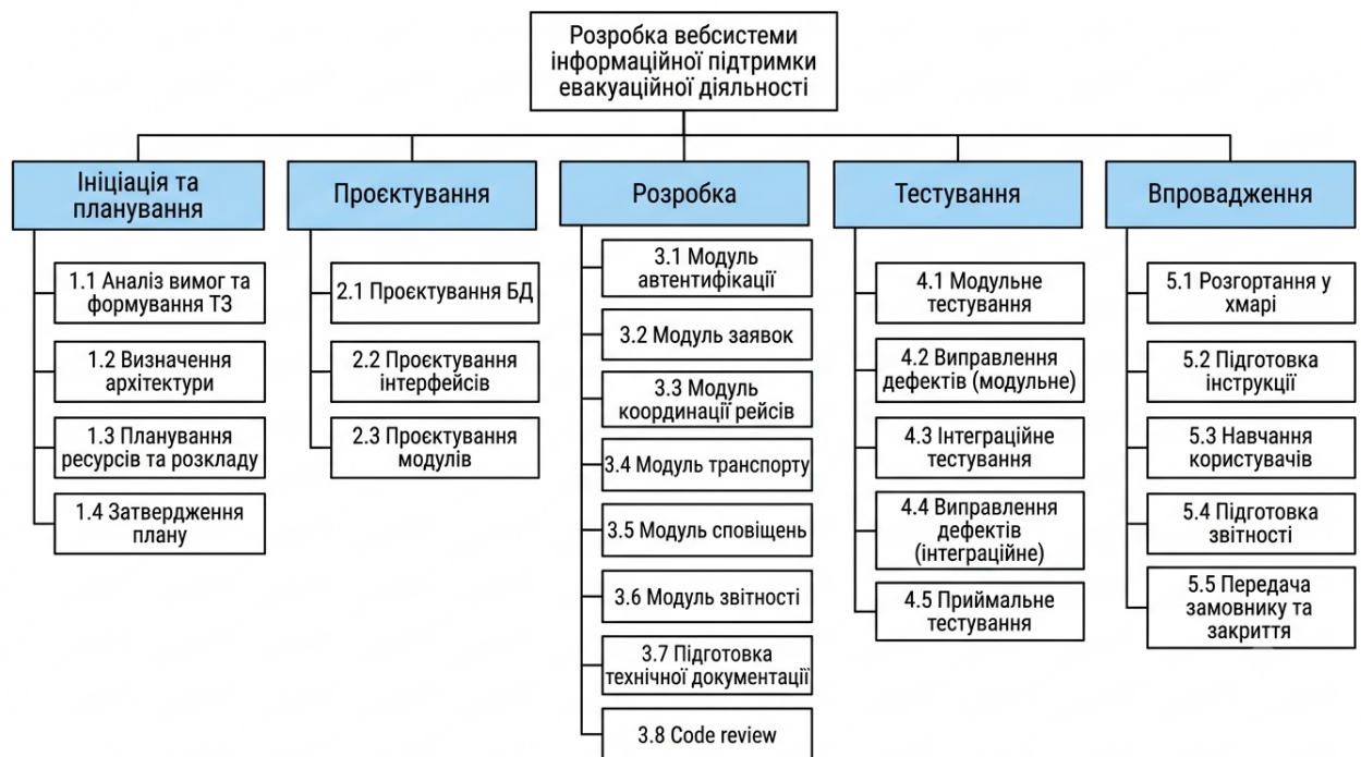
Рисунок 3.1 – Структура декомпозиції робіт (WBS) проєкту
