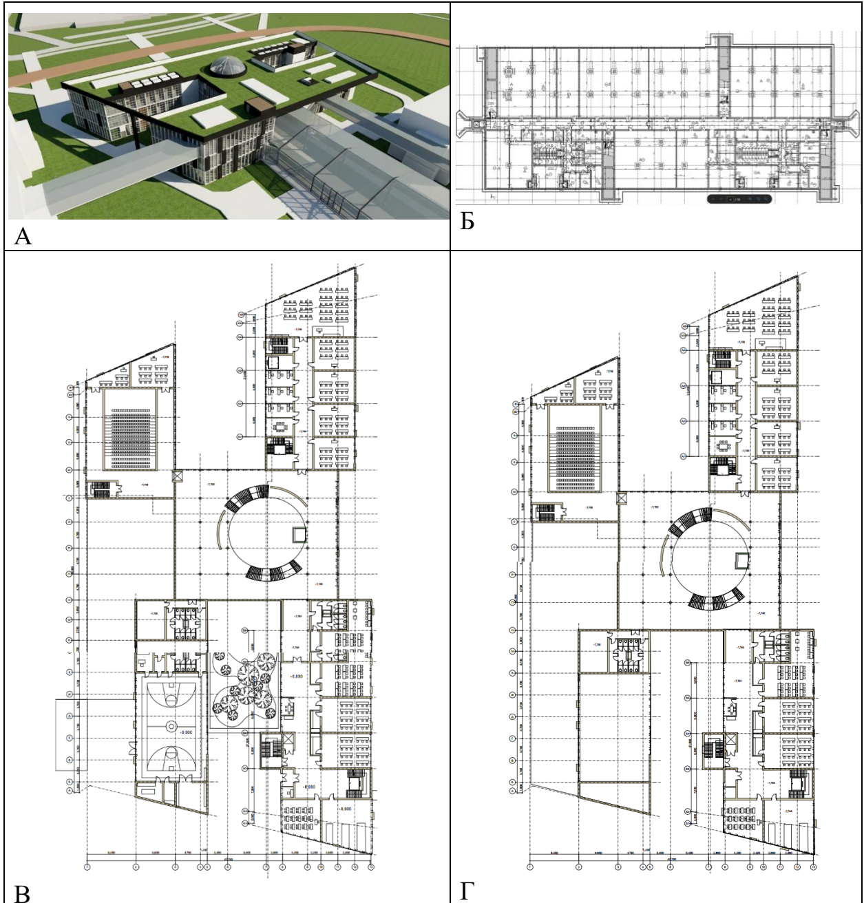
Рисунок 5.4 – Освітньо-спортивний корпус. А – Перспектива з «пташиного» польоту; Б – Бомбосховище (план); В – План на рівні 0.000; Г – План на рівні + 4.200 та 8.400.
