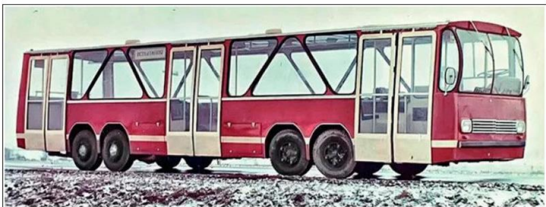
Рисунок 1.2 – Автобус з переднім приводом та електромеханічною трансмісією ЛАЗ-360 ЕМ
