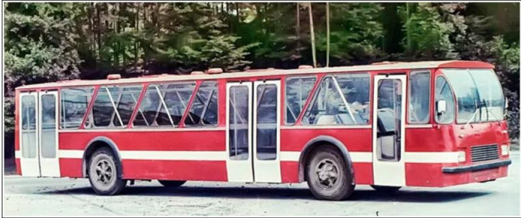
Рисунок 1.1 – Перший автобус з переднім приводом ЛАЗ-360
