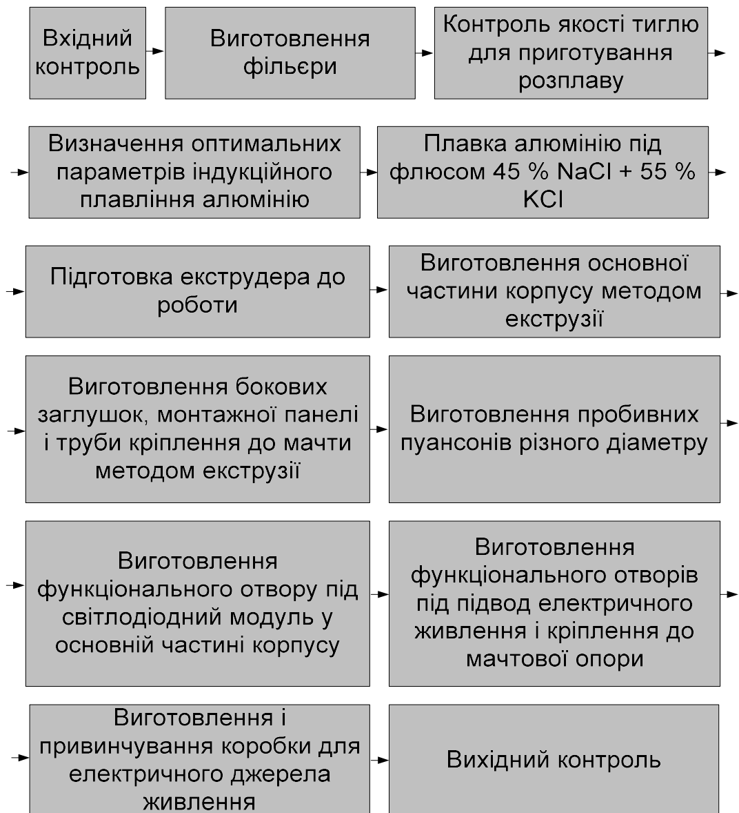
Рисунок 3.4 –Схему технологічного процесу виготовлення основних і допоміжних елементів конструкції світильника
