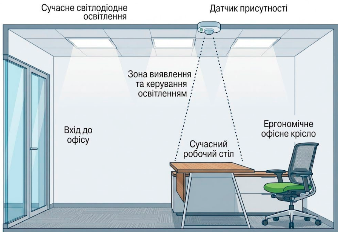
Рисунок 1.4 – Локалізована замкнена система зі стельовим сенсором
