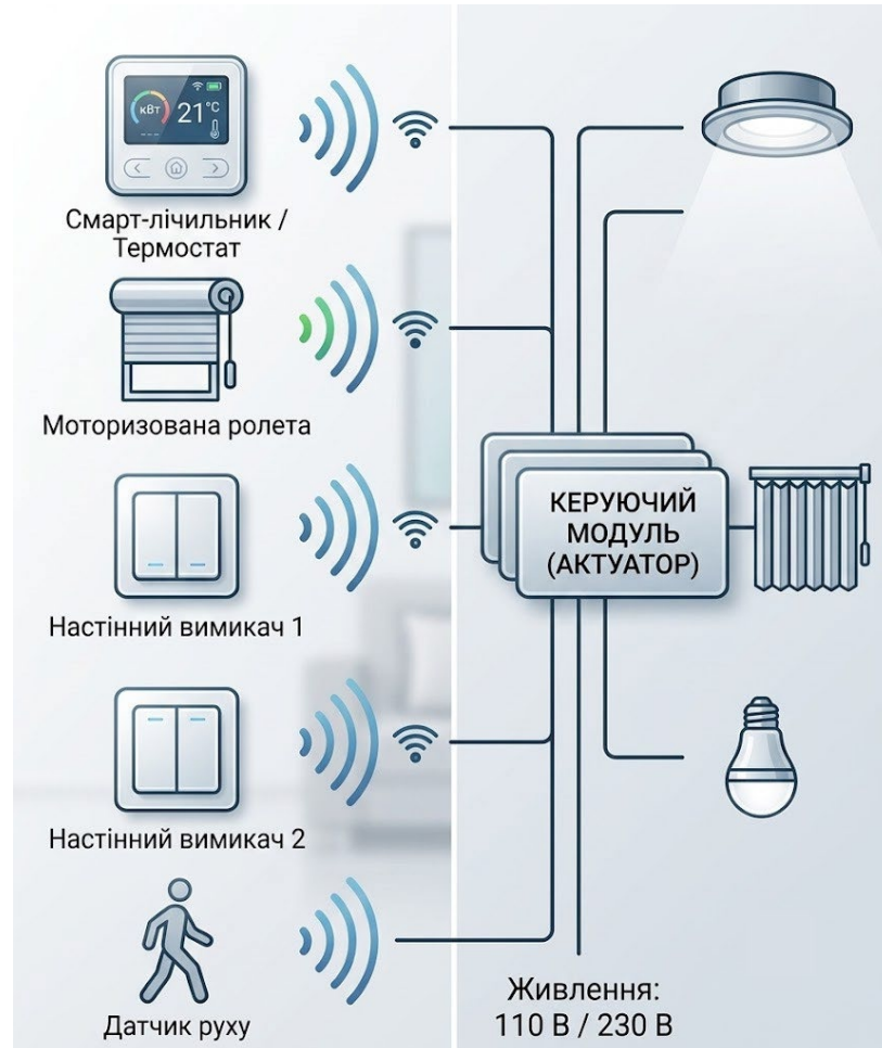
Рисунок 1.8 – Централізована система управління розумного будинку
