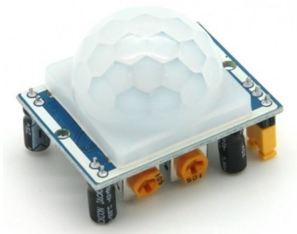
Рисунок 2.5 – Конструкція інфрачервоного датчика руху
