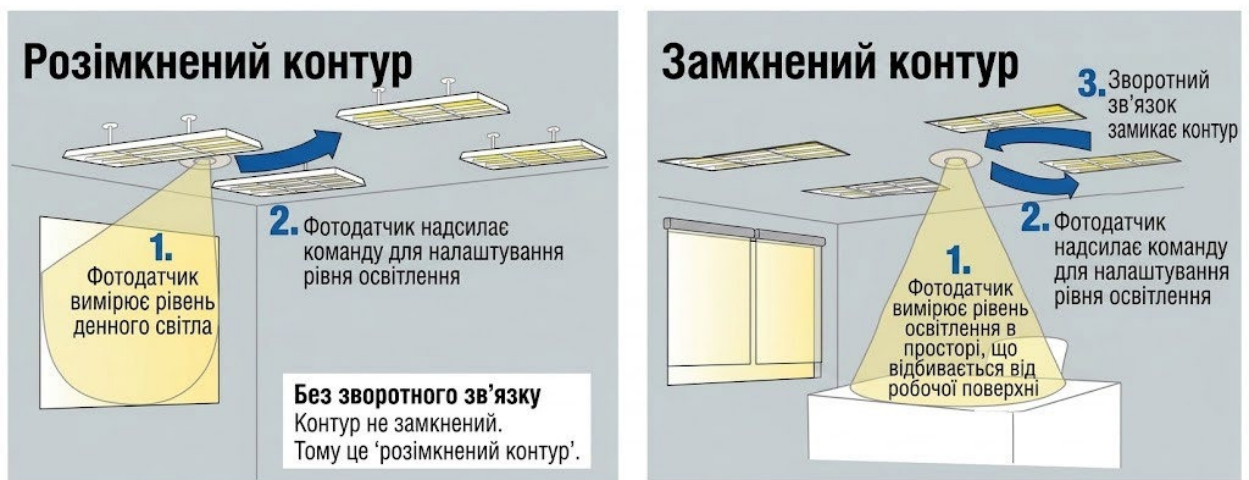
Рисунок 1.2 – Використання сенсорів у системах керування освітленням: зчитування зовнішніх параметрів освітленості (розімкнений контур) або внутрішніх параметрів (замкнений контур)
