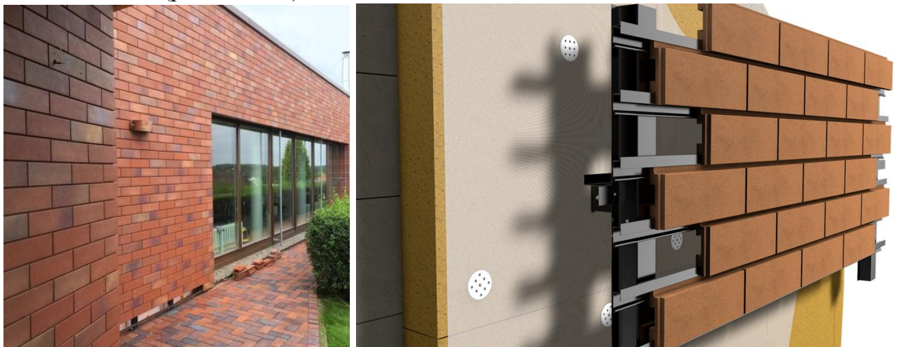
Рис. 16. а – приклад використання червоної клінкерної плитки, б – 3д-схема шарів зовнішньої стіни з вентиляльованим фасадом
