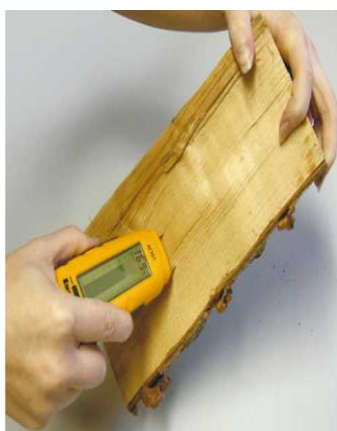
Рисунок 1.4 – Прилад для виміру вологості деревини
