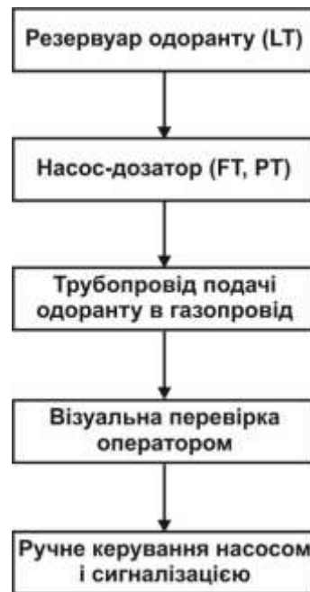
Рисунок 1.1 – Функціональна схема блоку одоризації газорозподільної станції до впровадження автоматизованої системи моніторингу
