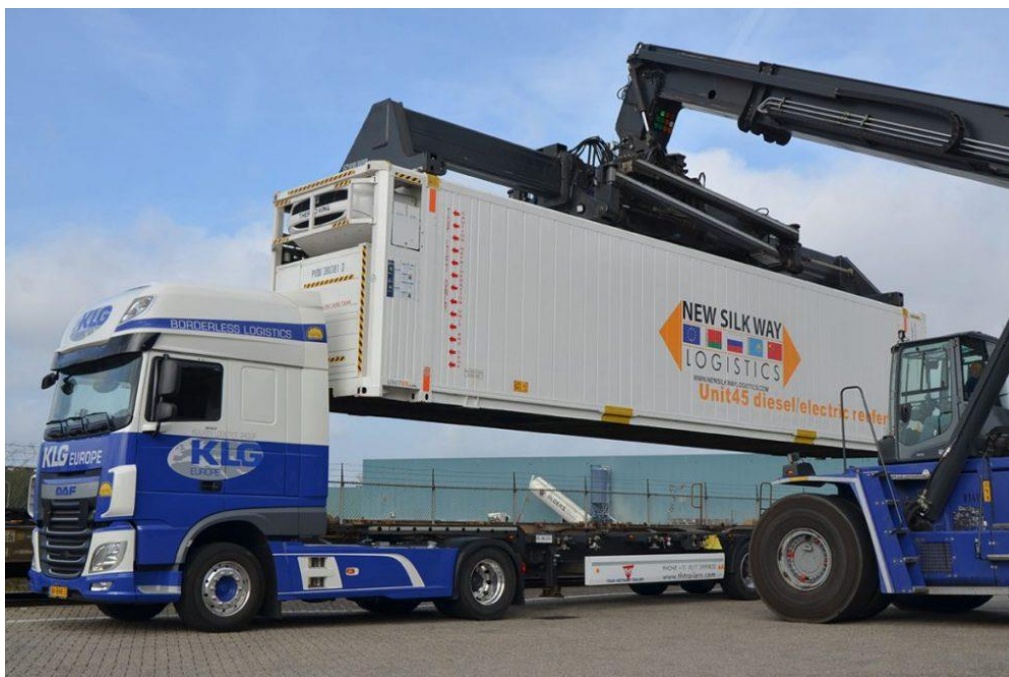
Рисунок 6.3 – Приклад навантаження 40-футового контейнера-рефрижератора на напівпричіп-контейнеровоз
