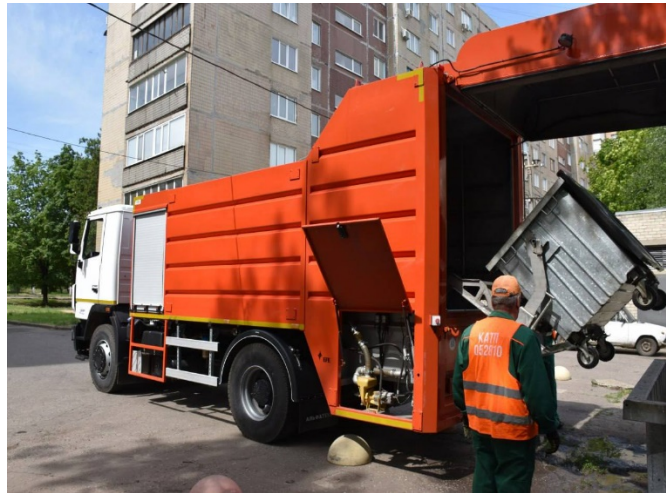
Рисунок 2.14 – Процес вивантаження чистого контейнера після мийки у спеціалізованому вантажному автомобілі СБМ МДКЗ МД
