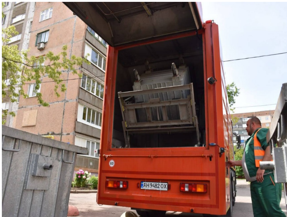
Рисунок 2.13 – Процес мийки контейнерів в спеціалізованому вантажному автомобілі СБМ МДКЗ МД
