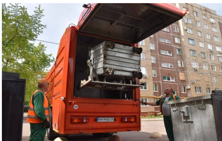
Рисунок 2.12 – Процес завантаження контейнерів в спеціалізований вантажний автомобіль СБМ МДКЗ МД
