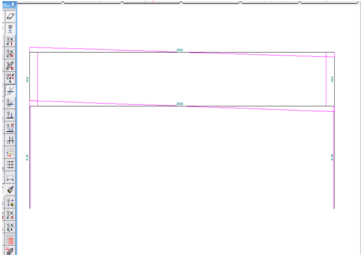
Рис. 2.5 – Перерізаючі зусилля в елементах рами
