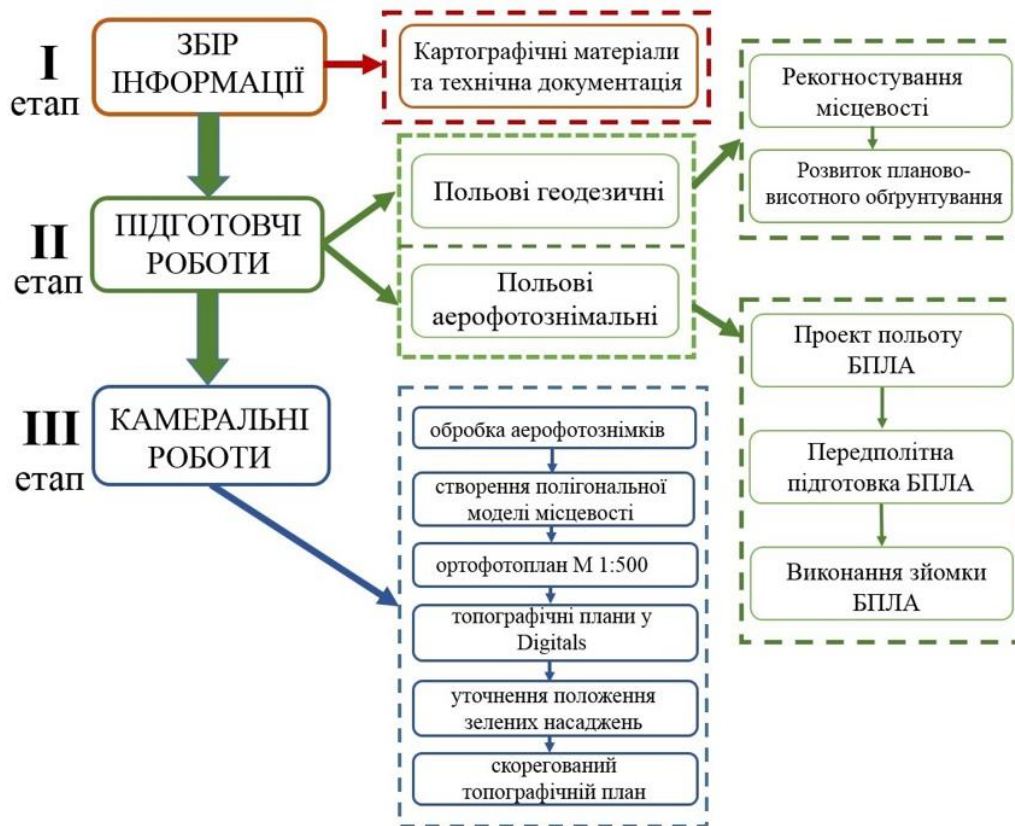
Рисунок 3.3 – Етапи проведення зйомки з використанням БПЛА [46]
