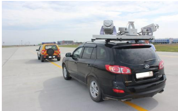
Рисунок 6.5 – Виконання зйомки мобільним лазерним сканувальним пристроєм
