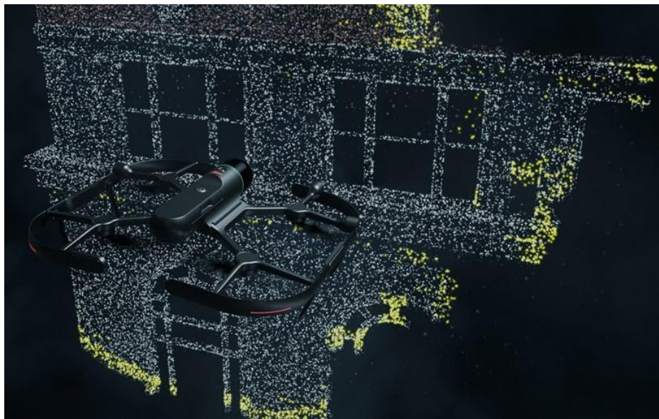
Рисунок 5.7 – Візуалізація роботи БПЛА з RTK модулем та LiDAR
