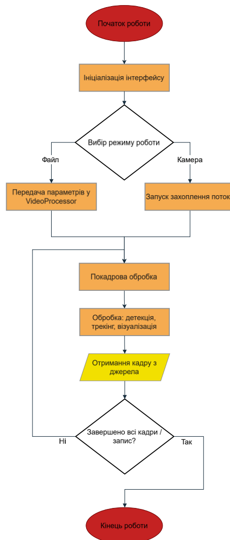
Рисунок 2.7 – Загальний алгоритм роботи системи
