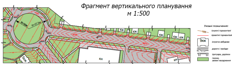
Рис.6 - Фрагмент вертикального планування методом проєктних горизонталей.
