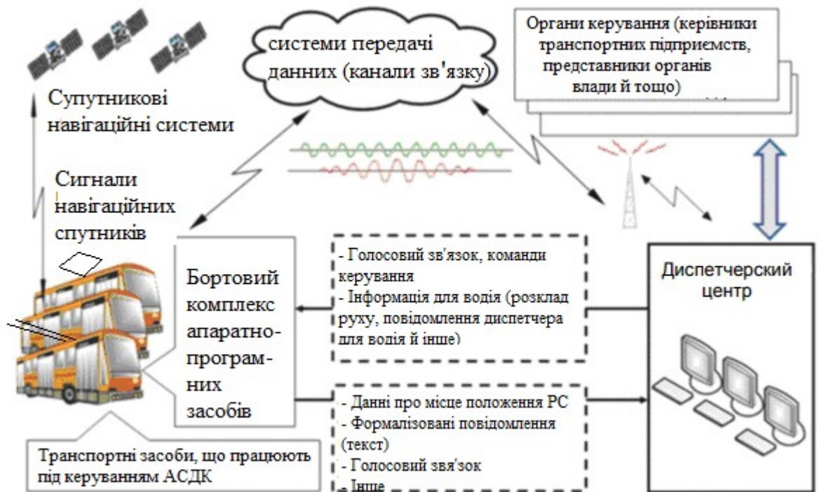
Рисунок 2.1 – Принципова схема роботи АСДК на базі супутникової навігації
