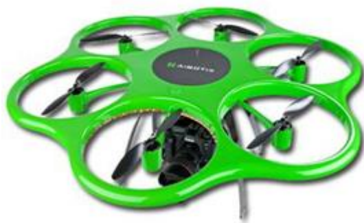
Рисунок 12 – Безпілотні аерофотознімальні вертольоти «Aibotix X6»
