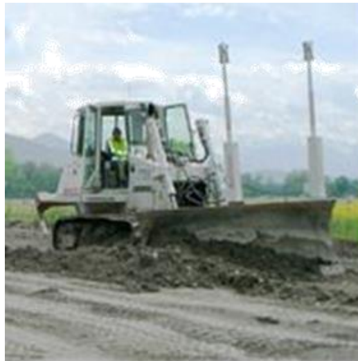
Рисунок 8 – Програмно-апаратний комплекс «Leica PowerGrade» для грейдерів і бульдозерів
