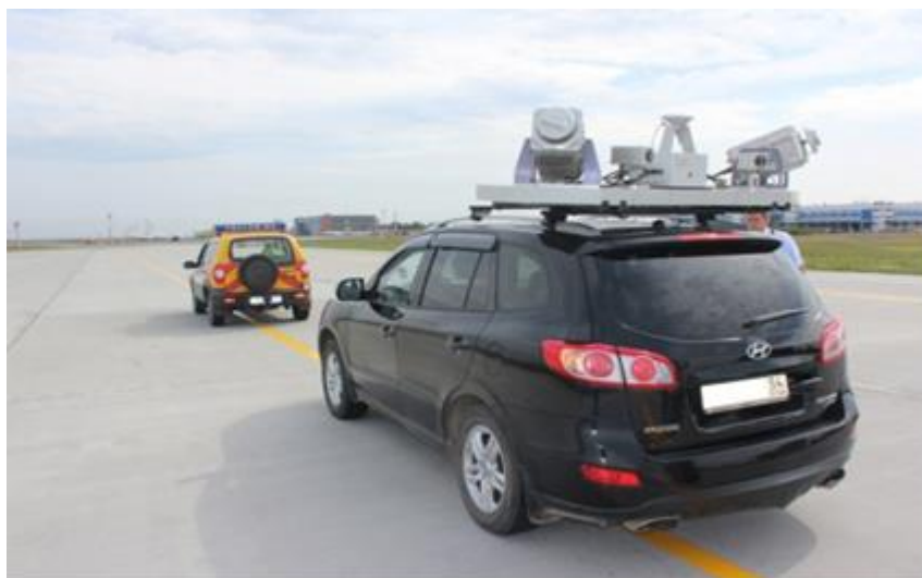
Рисунок 28 – Виконання зйомки мобільним лазерним сканувальним пристроєм
