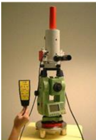
Рисунок 7 – Гіроскопічна насадка «Gyromax AK-2M»
