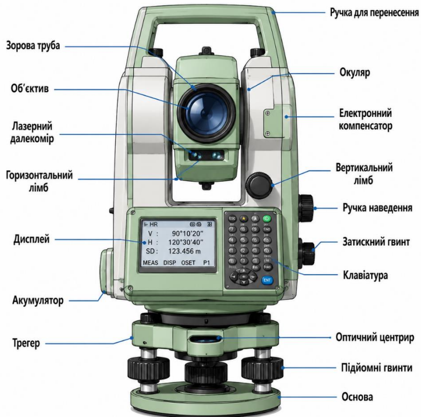
Рисунок 19 – Схема на прикладі електронного тахеометра «TOPCON GPT-3000» – вигляд спереду
