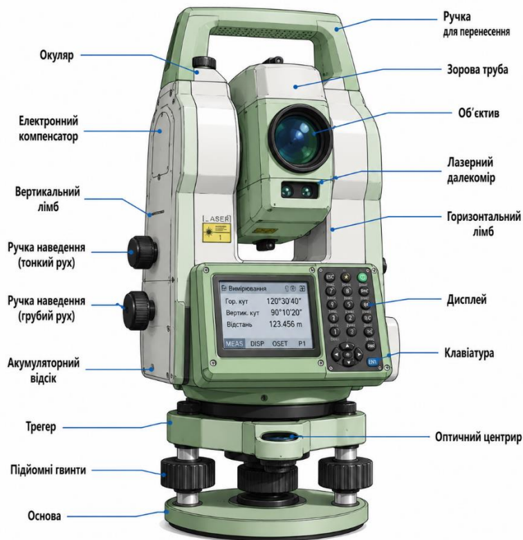
Рисунок 20 – Схема на прикладі електронного тахеометра «TOPCON GPT-3000» – вигляд ззаду
