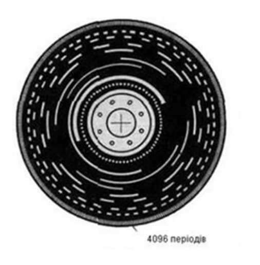
Рисунок 4 – Приклад кодованого круга в електронному теодоліті
