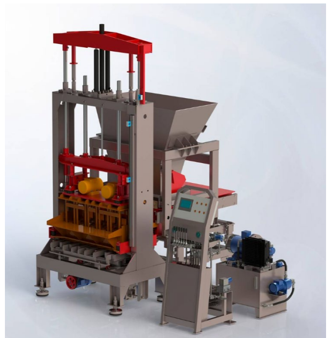
Рисунок 2.5 – Вібропрес ПС 150 ПА
