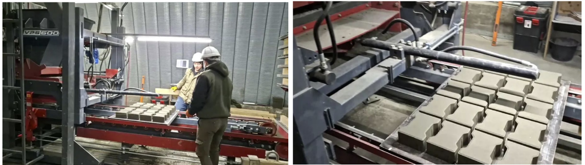
Рисунок 1.1 – Процес виробництва елементів методом вібропресування на підприємстві виробничої компанії ПІК ПК
