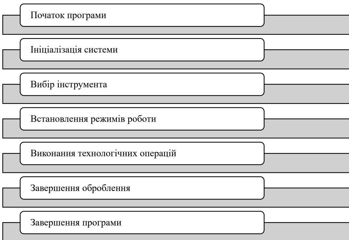
Рис. 2.4 – Загальна структура керуючої програми
