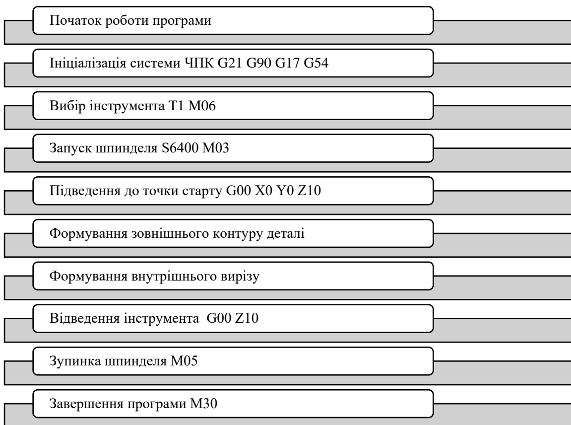
Рис. 3.4 - Алгоритм формування керуючої програми
