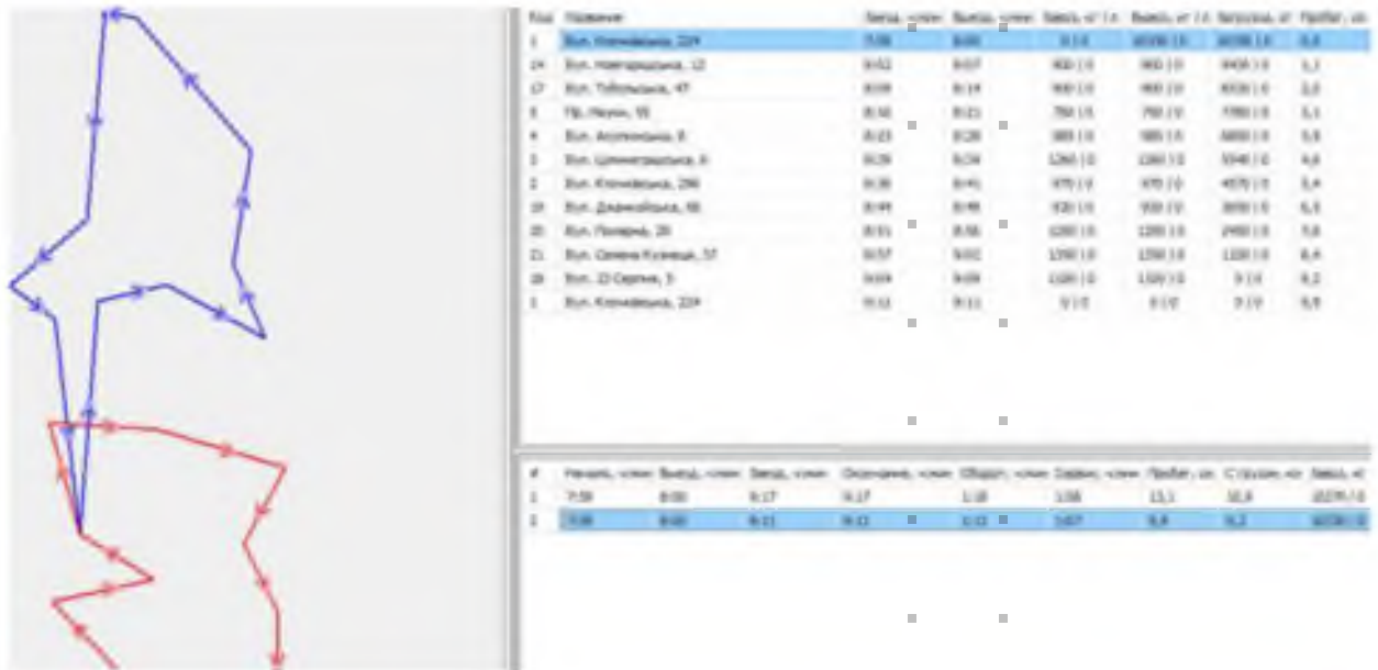
Рисунок 3.5 – Окремий фрагмент програми розробки маршрутів для перевезення матеріального потоку транспортним засобом MAN 19
