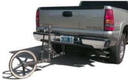
Рисунок 1.2 – Спосіб монтажу пристрою «п'яте колесо» на транспортному засобі [6]
