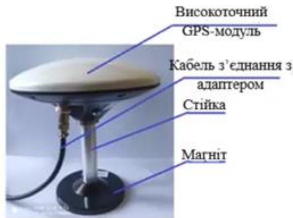
Рисунок 1.4 – Прилад для оцінювання ефективності гальмівної системи трамвая і тролейбуса ВЕГС-01 на підставі GPS-системи [8]
