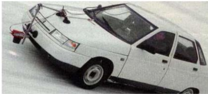
Рисунок 1.3 – Оптичний комплекс від фірми «Datron», що оцінює гальмівну систему під час динаміки транспортного засобу [6]
