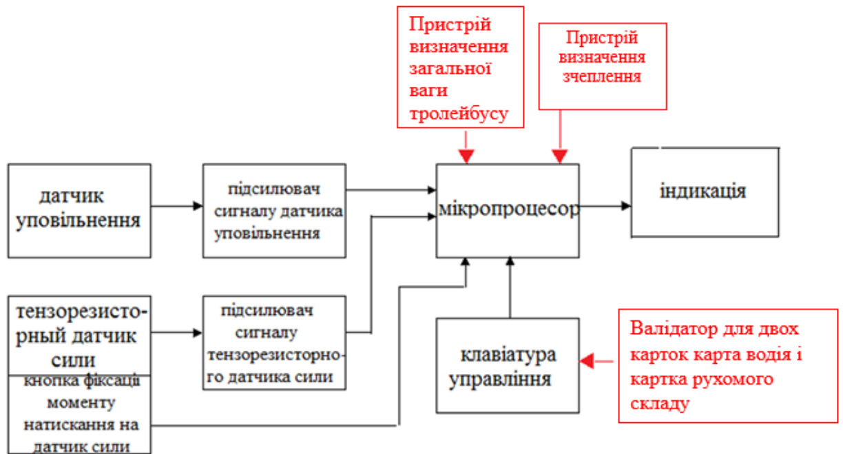
Рисунок 1.8 – Головні блоки модернізації пристрою приладу «Ефект - 02»
