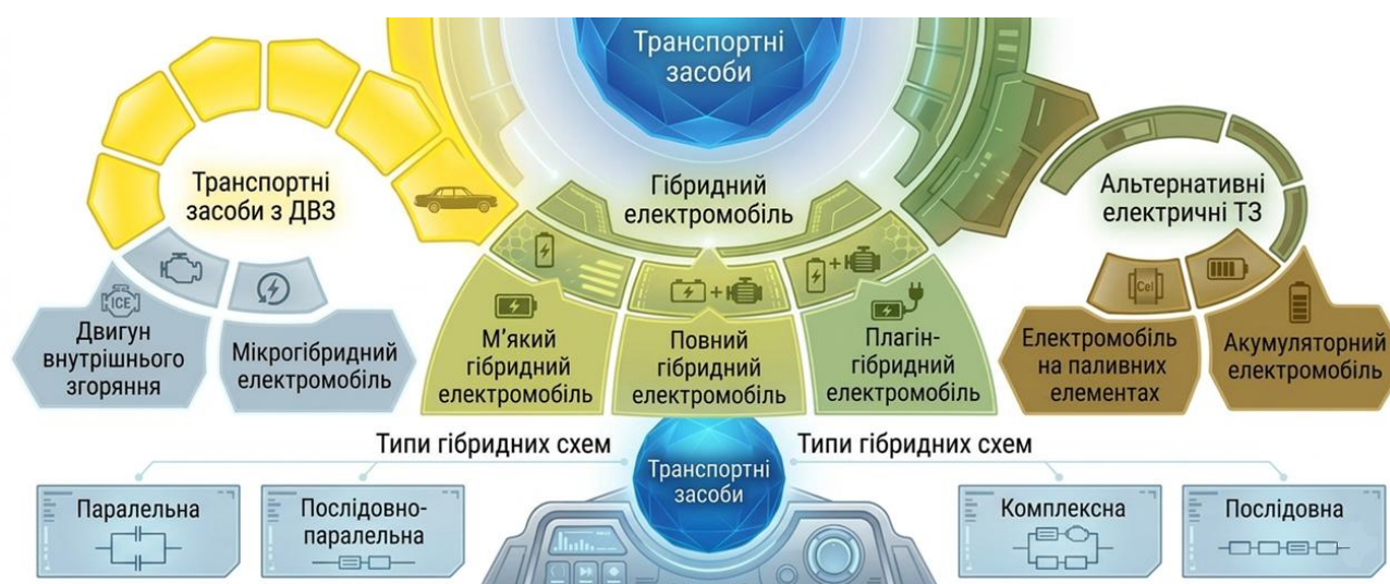
Рисунок 1.2 – Типи електромобілів залежно від архітектури конструкції
