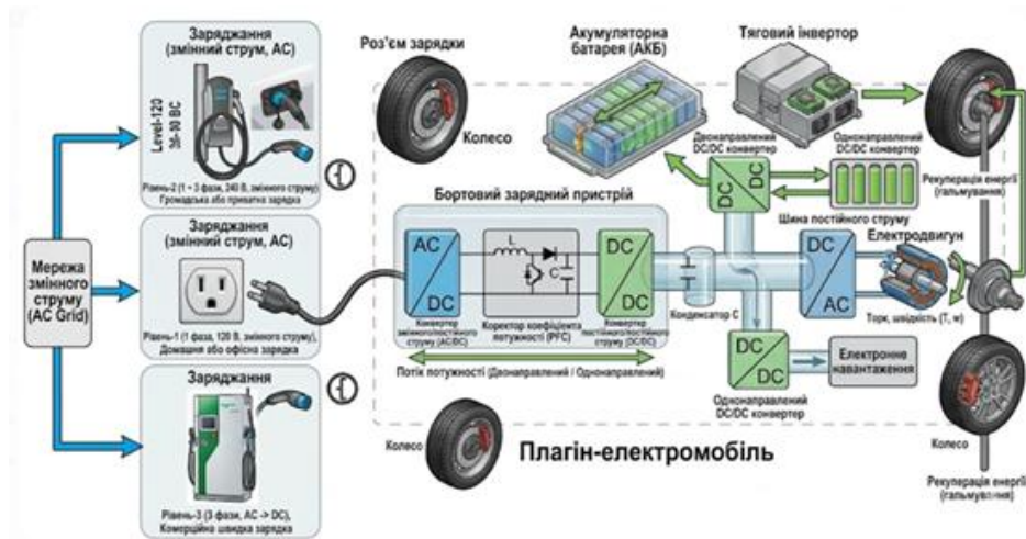
Рисунок 1.7 – Схема односпрямованого та двонаправленого потоку потужності в технології V2G з номінальною потужністю зарядного пристрою
