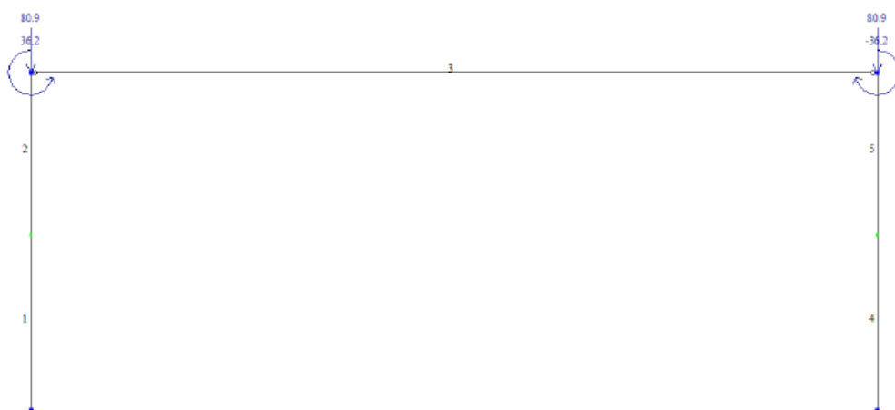
Рисунок 2.2.3 – Розрахункова схема навантаження від ферми покриття
