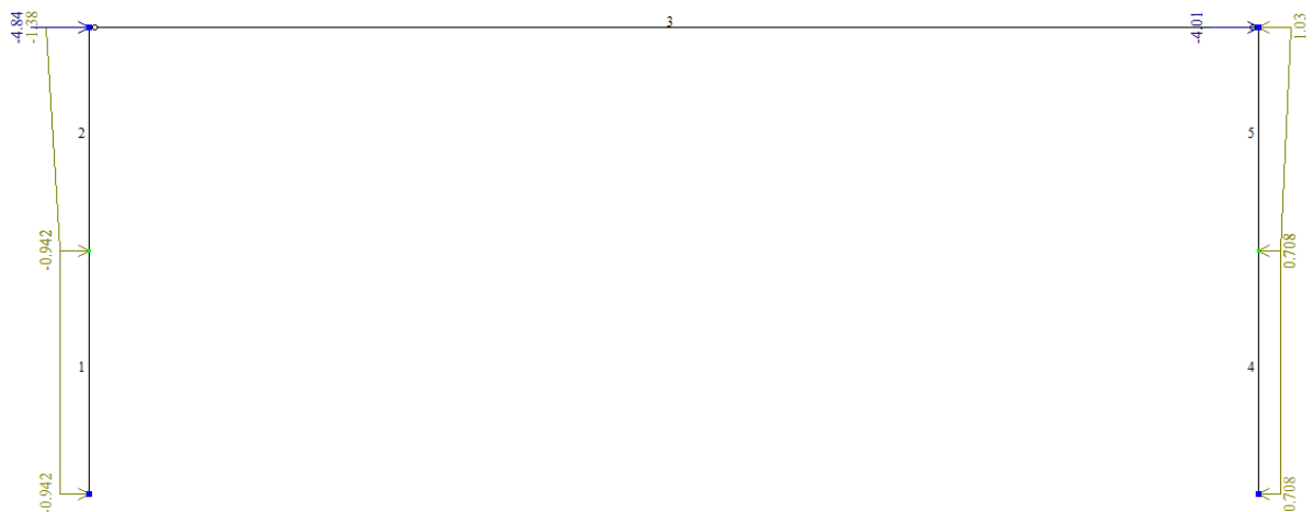
Рисунок 2.2.15 Розрахункова схема вітрового навантаження Л-П.
