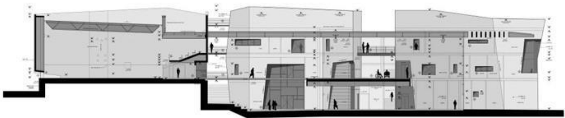
Рисунок 1.9. Розріз з розкриттям на укріття та підземний поверх
