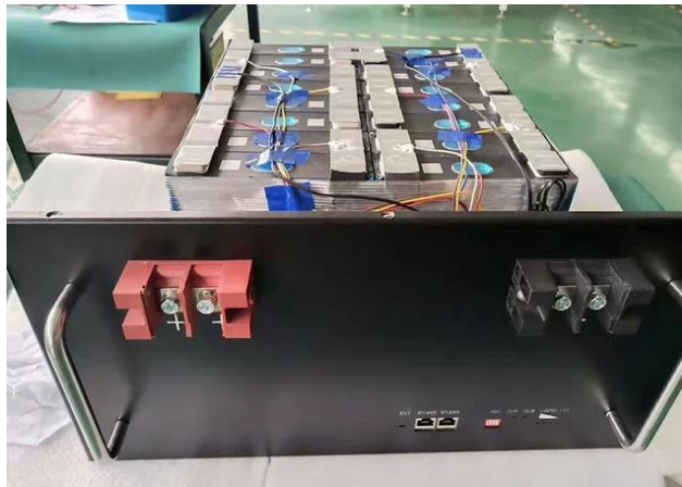
Рисунок 1.19 Розташування комірок акумулятора всередині блоку
