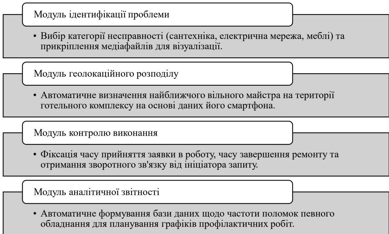
Рис. 3.4. Функціональна структура модуля диспетчеризації технічних запитів у корпоративному Telegram-боті
