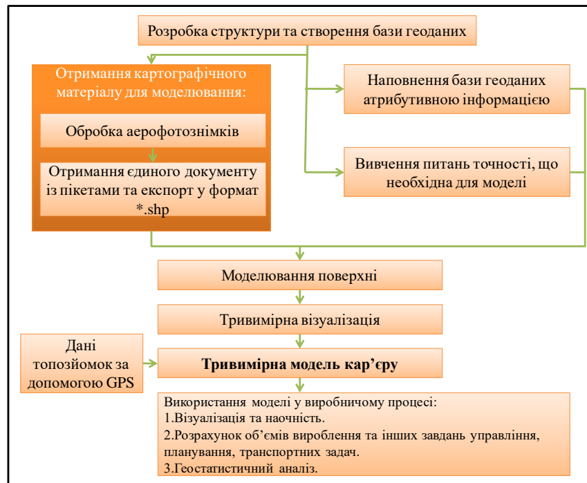
Рисунок 2.16 – Технологія просторового моделювання кар'єру
