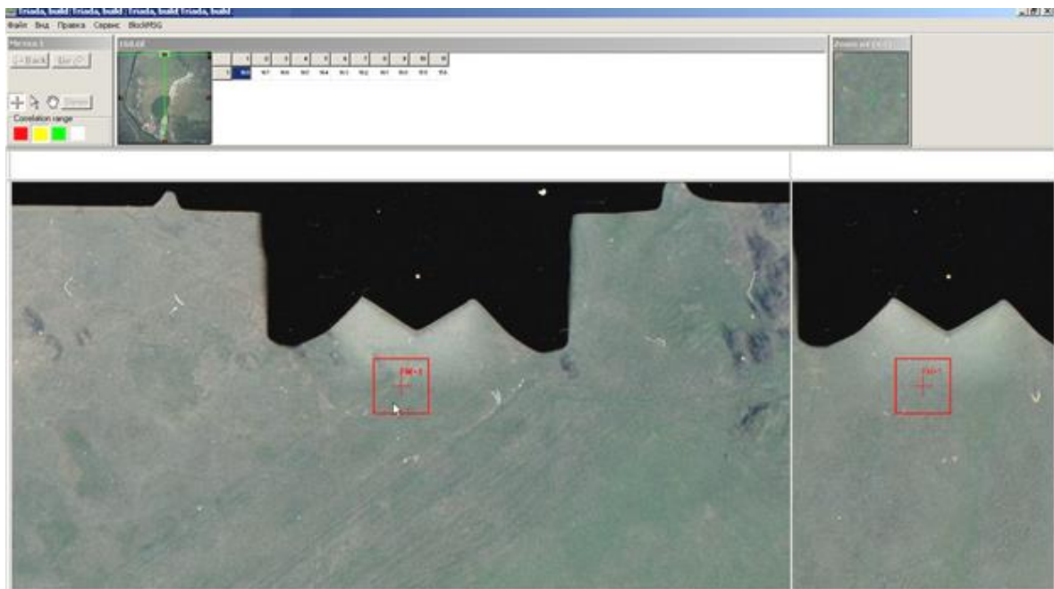
Рисунок 2.8 – Вікно програми, модуль Triada.exe. Початок внутрішнього орієнтування знімків – перша координатна мітка
