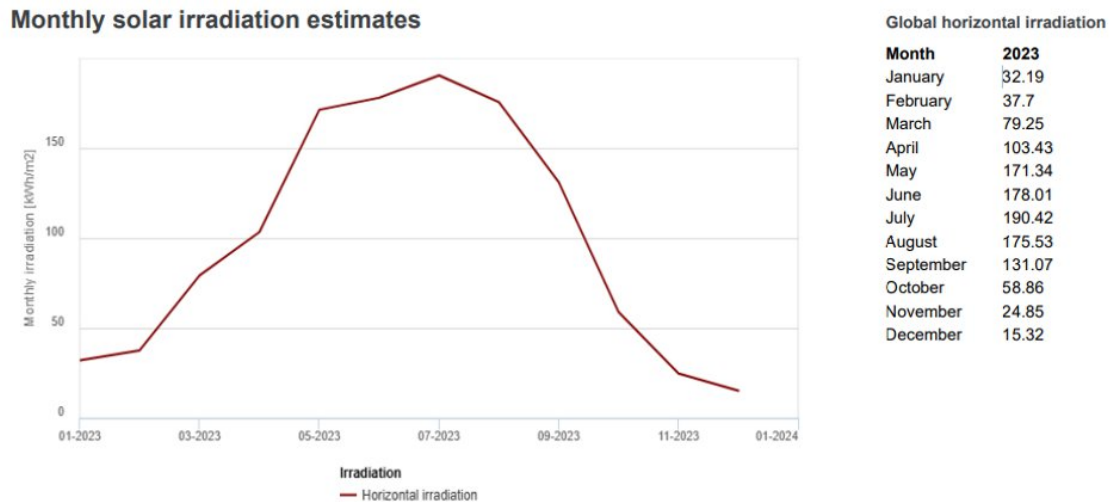
Рисунок 1.7 – Графік залежності та числові значення щомісячного значення сонячної інсоляції за 2023 рік для широти \varphi = 49,94^\circ
