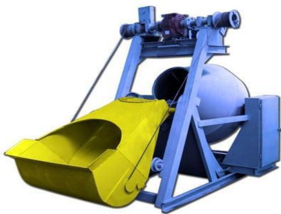
Рисунок 6.1 – Гравітаційні бетонозмішувачі циклічної дії: а – стаціонарний; б – пересувний
