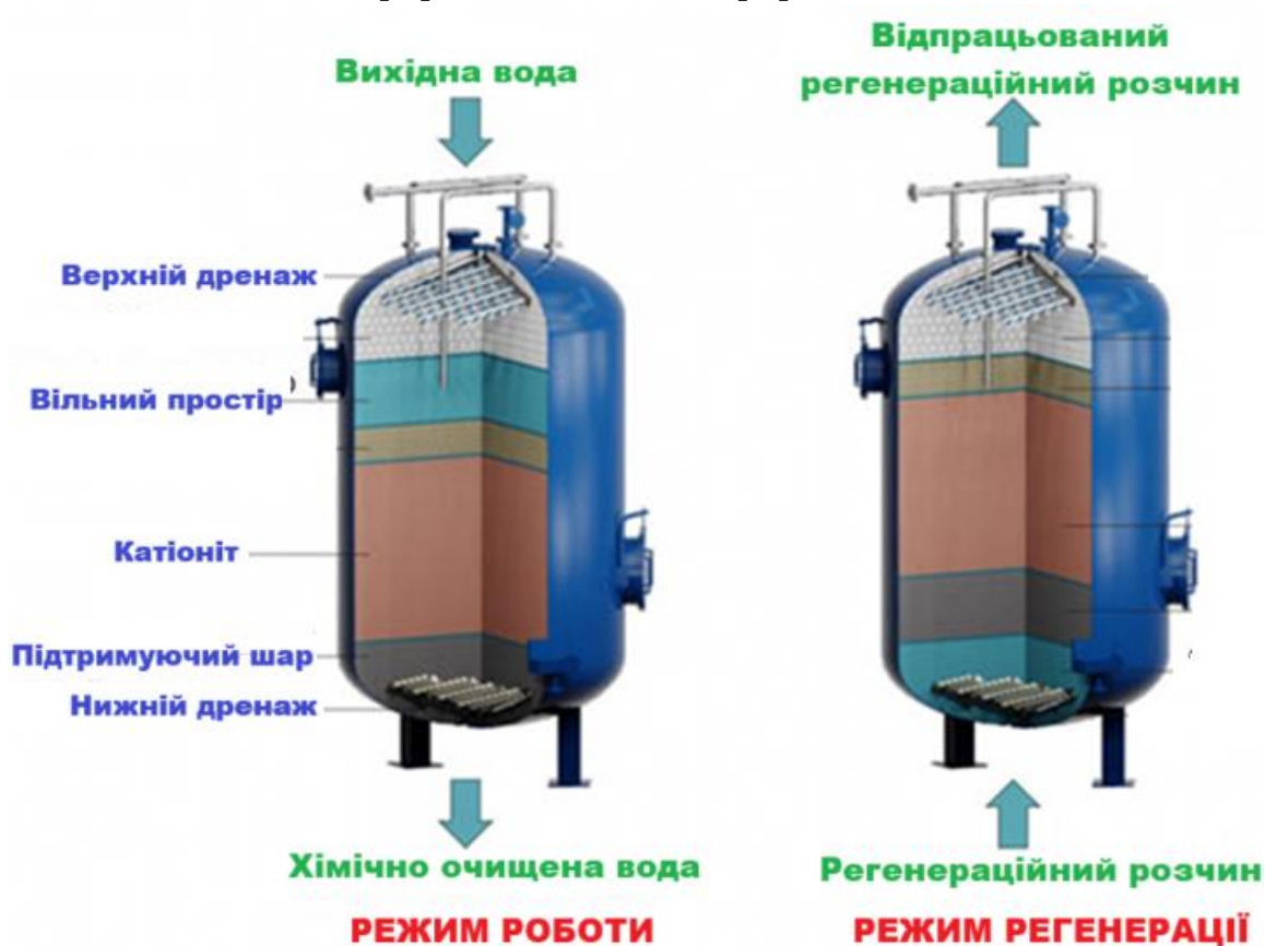
Рисунок 2.4 – Схема роботи катіонітового фільтра
